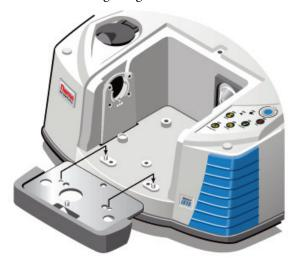
4. Setzen Sie die Schrauben aus dem Probenraumerweiterungs-Satz in die Öffnungen der Probenraumerweiterung ein und ziehen Sie die Schrauben dann mit dem Multi-Funktions-Werkzeug mit aufgesetztem Kreuzschlitz-Bit fest. (Die Schrauben dürfen nur handfest angezogen werden.)
