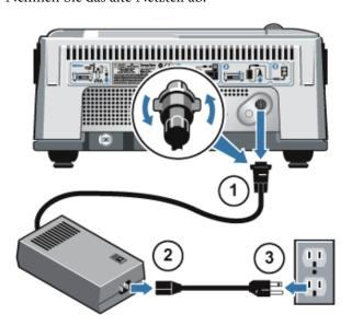
**Hinweis** Drehen Sie den Feststellring am Steckverbinder des Netzteils, bis dieser einrastet.
