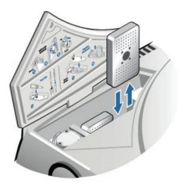
3. Bauen Sie mit dem Multi-Funktions-Werkzeug die Trockenmittelabdeckung wieder ein, legen Sie das Multi-Funktions-Werkzeug wieder in das Werkzeugfach und schließen Sie die Klappe des Werkzeugfachs.
