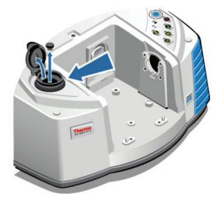
2. Füllen Sie die Vakuumflasche aus Metall mit flüssigem Stickstoff.
