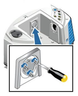
**Hinweis** Die Quelle darf beim Ausbauen nicht gedreht werden und die elektrischen Kontakte bzw. die Komponenten der Quelle dürfen nicht berührt werden.
