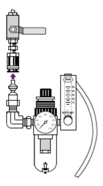
5. Schließen Sie die Spüleinheit an das Gerät an, stellen Sie die Bedienelemente für das Spülgas ein und schließen Sie das Verbindungsstück dann hinten am Gerät an, bis es einrastet.
