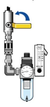
2. Stellen Sie den Druckregler ein, bis der Druckmesser einen Druck zwischen 0,7 und 1,4 bar (70 bis 140 kPa) anzeigt.
