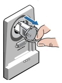
**HINWEIS** Die neue Quelle darf beim Einsetzen nicht gedreht werden. Richten Sie zum Einsetzen der neuen Quelle die Kerbe oben in der Quelle mit dem Stift im Quellenhalter aus.
