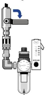
2. Entfernen Sie die Kunststoffkappe des Filters. (Sie können die Kappe mit der Hand abschrauben.)
