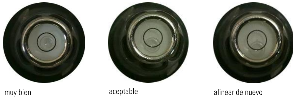
Figura 6. Posición de la burbuja de aire en el nivel esférico
