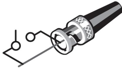
**Hinweis** Beim Öffnen des Schalters wird der Laserstrahl unterbrochen und beim Schließen des Schalters wird der Strahl wieder freigegeben.
