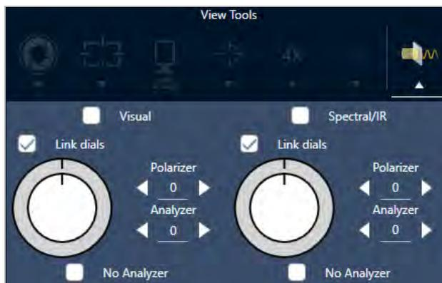
4. Sélectionnez Visual (Visuel) pour utiliser le polariseur de lumière visible. Sélectionnez Spectral/IR (Spectral / IR) pour utiliser le polariseur IR.
