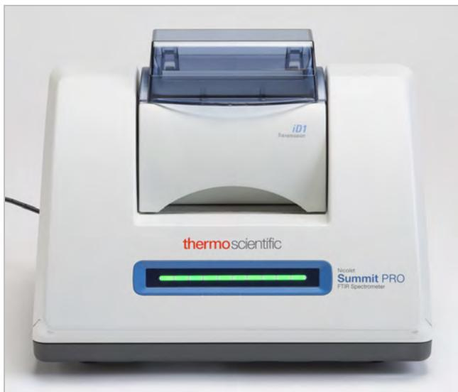
Retirez l'échantillon de votre accessoire ou du support d'échantillon afin que le spectromètre puisse effectuer une mesure précise du bruit de fond une fois prêt à l'emploi. Le couvercle de l'accessoire iD1 peut être ouvert ou fermé. (Si votre accessoire de transmission est purgé avec de l'air sec ou de l'azote, maintenez le couvercle fermé sauf si vous ajoutez ou retirez un échantillon.)
