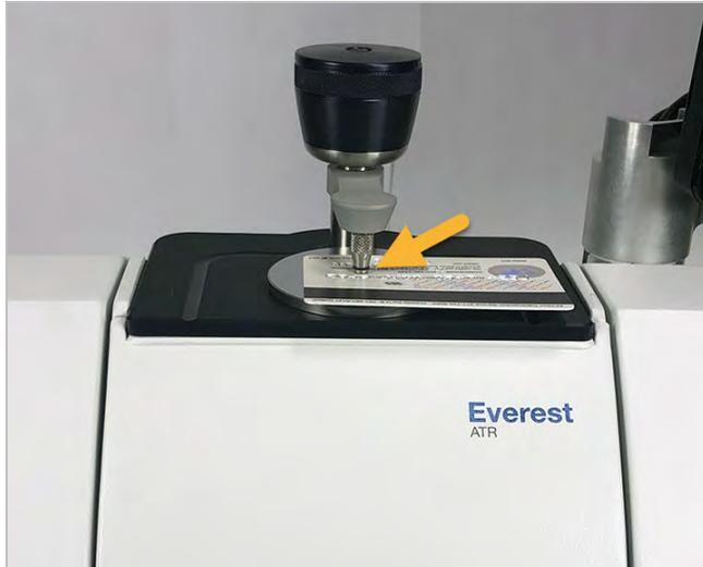
Une fois l'échantillon en place, cliquez sur **Preview Sample (Aperçu échant.)** pour obtenir un aperçu des données de l'échantillon dans le panneau spectral. Si les pics affichés dans l'aperçu du spectre sont très petits, utilisez un échantillon liquide plus concentré. Si vous mesurez un solide, repositionnez l'échantillon sur le cristal ATR puis réappliquez la pression.
