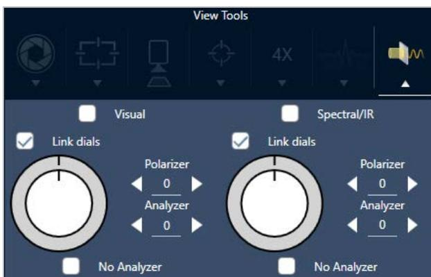
4. Seleccione Visual para utilizar el polarizador de luz visible. Seleccione Spectral/IR (Espectral/IR) para utilizar el polarizador de IR.
