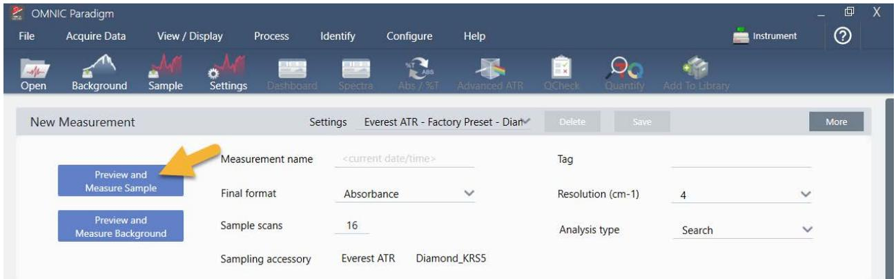
El análisis comienza con una medición de fondo. El único requisito del fondo de ATR es que el cristal esté limpio. El espectro de fondo se usa para eliminar las señales de los datos de la muestra originadas por el espectrómetro, el cristal de ATR o el entorno del fondo.
