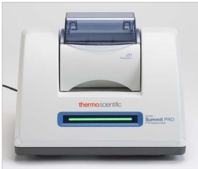
Retire las muestras del accesorio o portamuestras para que el espectrómetro pueda tomar una medición del fondo exacta cuando esté preparado. La cubierta del accesorio iD1 puede estar abierta o cerrada. (Si el accesorio de transmisión se purga con aire seco o nitrógeno, mantenga la cubierta cerrada a menos que vaya a agregar o retirar una muestra.)
