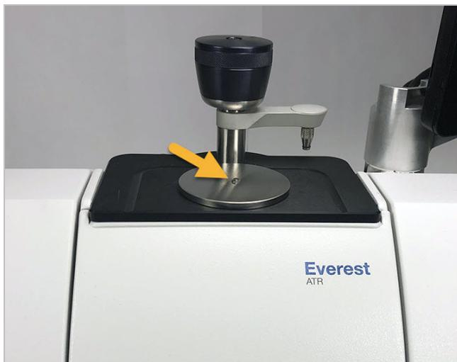
Si la muestra es sólida, gire el mando de la torre de presión en sentido antihorario para levantar el brazo. A continuación, coloque la muestra en el cristal y gire el mando en sentido horario para bajar el brazo. Continúe girando el mando hasta que encaje. Para esta demostración, vamos a medir una tarjeta plástica.
