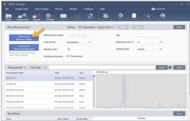
El análisis comienza con una medición de fondo. El único requisito de un fondo de transmisión es que no haya ninguna muestra en la trayectoria del haz infrarrojo. El espectro de fondo se usa para eliminar las señales de los datos de la muestra originadas por el espectrómetro, el accesorio de transmisión o portamuestras, o el entorno del fondo.
