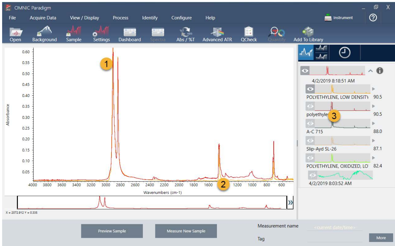
Figura 3-3: Risultato del campione e miglior risultato visualizzati assieme utilizzando la stessa scala dell'asse delle Y
