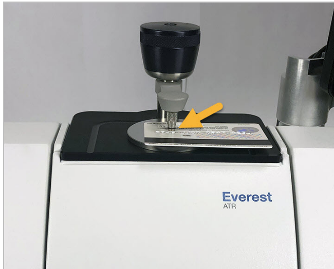
Figura 3-2: Misurazione di un solido con ATR
