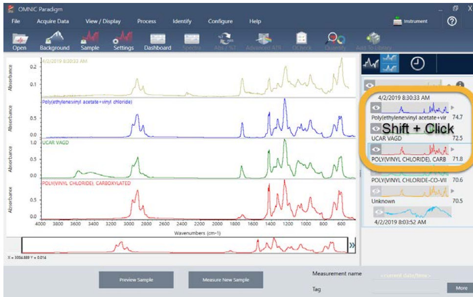
图 3-8: 显示数个相似匹配的分层谱图
