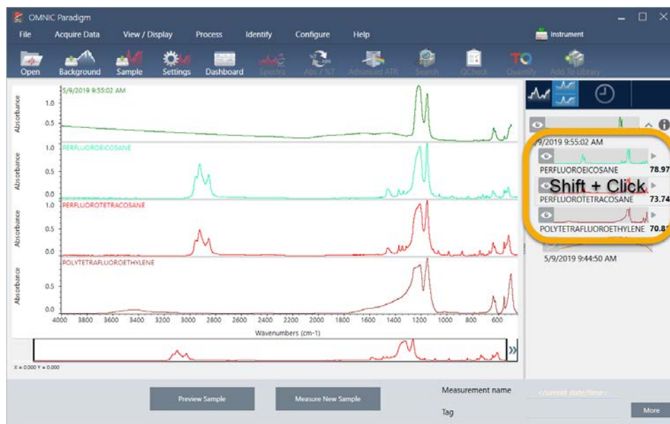
图 3-9: 显示数个相似匹配的分层谱图
