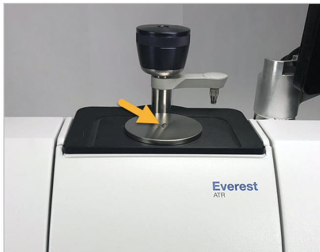
图 3-1:使用 ATR 测量液体
