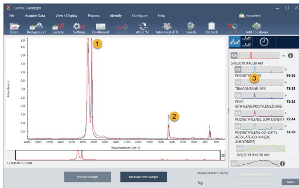
图 3-4:使用相同的 Y 轴刻度一起显示的样品和最佳搜索结果
