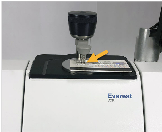
图 3-2:使用 ATR 测量固体
