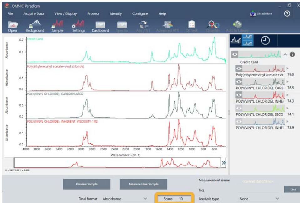
Eine Möglichkeit besteht darin, zum Dashboard zurückkehren und die Auflösungseinstellung für die unbekannte Probe zu ändern. Beispielsweise können Sie das Spektrum mit einer höheren Auflösung erfassen, indem Sie eine niedrigere Auflösung einstellen. Wenn die Proben-Peaks dann eindeutiger oder zahlreicher sind, erhalten Sie möglicherweise ein besseres Analyseergebnis.
