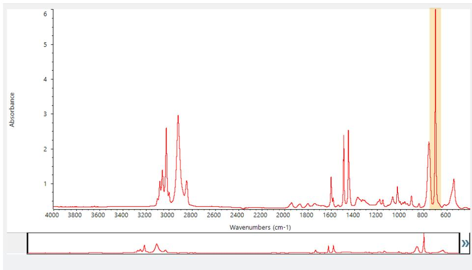
Diese Peaks mit flacher Spitze werden als „vollständig absorbierend“ bezeichnet und können übermäßiges spektrales Rauschen enthalten, das sich negativ auf die Analyseergebnisse auswirkt. Zum Ausschließen eines vollständig absorbierenden Peak öffnen Sie die Sucheinstellungen, deaktivieren die Option „Use full spectral range“ (Gesamten Spektralbereich verwenden) und geben dann die zu durchsuchenden Bereiche an, die den vollständig absorbierenden Bereich ausschließen.
