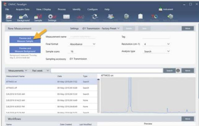
Die Analyse beginnt mit einer Messung des Hintergrunds. Die einzige Voraussetzung für einen Transmissionshintergrund ist, dass die Probe aus dem Strahlungsweg des Infrarotstrahls zu entfernen. Das Hintergrundspektrum wird verwendet, um alle Signale in den Probandaten zu entfernen, die auf das Spektrometer, das Transmissionszubehör oder die Hintergrundumgebung zurückzuführen sind.
