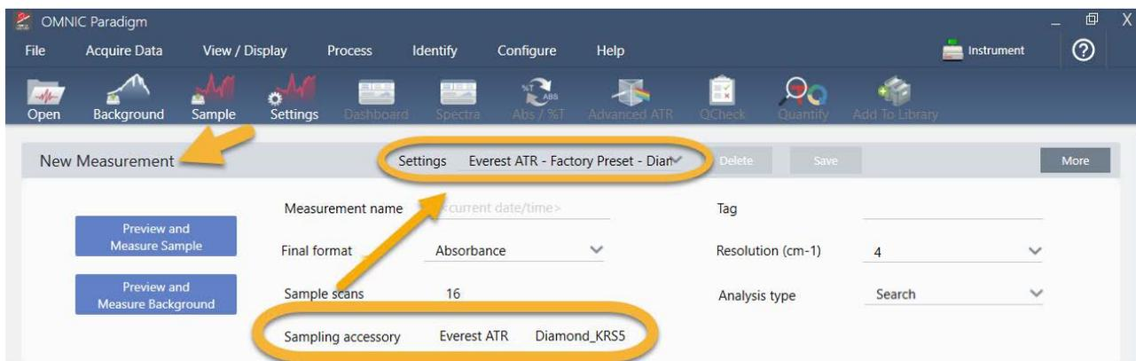
Stellen Sie zunächst sicher, dass die Anzeige „Sampling Accessory“ (Probennahmezubehör) das installierte Zubehör anzeigt. Anderenfalls setzen Sie das Zubehör erneut ein. Beachten Sie, dass die werksseitigen Voreinstellungen für dieses Zubehör unter „Settings“ (Einstellungen) angezeigt werden.
