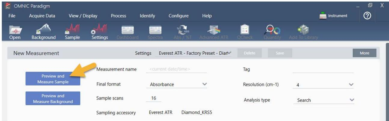
Die Analyse beginnt mit einer Messung des Hintergrunds. Die einzige Voraussetzung für eine ATR-Hintergrundmessung ist ein sauberer Kristall. Das Hintergrundspektrum wird verwendet, um alle Signale in den Probandaten zu entfernen, die auf das Spektrometer, den ATR-Kristall oder die Hintergrundumgebung zurückzuführen sind.
