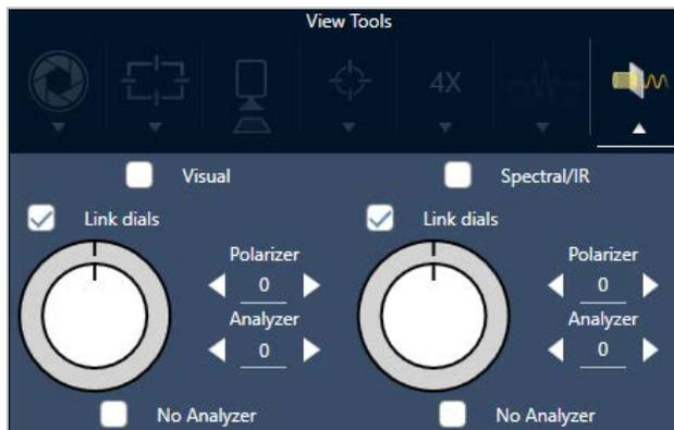
4. Wählen Sie „Visual“ (Sichtbar), um den Polarisator für sichtbares Licht zu verwenden. Wählen Sie „Spectral/IR“ (Spektral/IR), um den IR-Polarisator zu verwenden.
