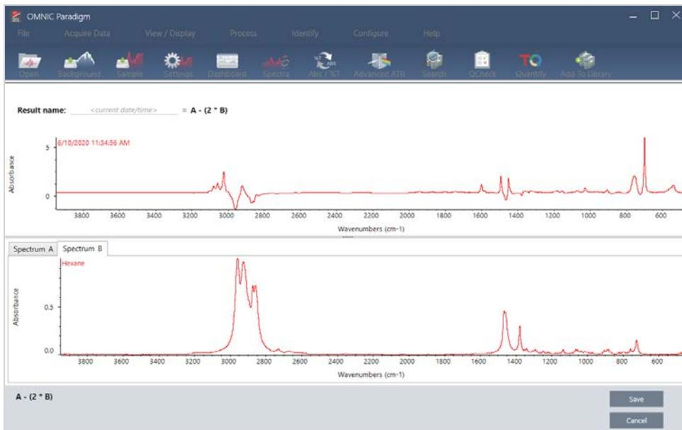
Die Ergebnisvorschau zeigt das Spektrum an, das sich aus Ihrer Gleichung ergibt, sowie jede der in der Gleichung verwendeten Spektren. Das Ergebnis wird im oberen Fenster, Ihre Referenzspektren werden im unteren Fenster angezeigt.
