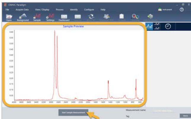
Wenn das Spektrum keine Proben-Peaks aufweist, überprüfen Sie, ob das Probenmaterial Energie im Infrarotbereich des Lichtspektrums absorbiert. Stellen Sie hingegen zusätzliche Peaks im Spektrum fest, überprüfen Sie, ob der Kristall sauber ist.
