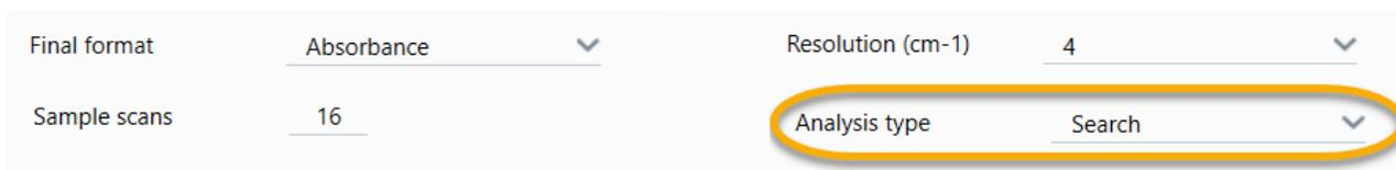
Abschließend überprüfen Sie die Erfassungseinstellungen (Probenscans, Auflösung und endgültiges Format). Die oben gezeigten Einstellungen sind gute Ausgangswerte für diese Analyse.
