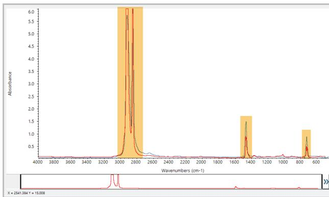
Klicken Sie auf die Schaltfläche „Stack“ (Gestaffelte Anzeige), um die beiden Spektren so zu skalieren, dass sie jede y-Achse ausfüllen. Auch hier stimmen die Spektren im Wesentlichen überein, abgesehen von der leicht erhöhten Basislinie im niederfrequenten Bereich des Probenspektrums. Aus diesem Ergebnis können wir schließen, dass es sich bei der Probe um Polyethylen handelt. Die Analyse ist abgeschlossen.
