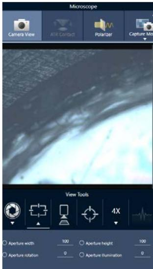
2. Verwenden Sie die Schieberegler oder geben Sie einen genauen Wert ein, um die Höhe, Breite und Drehung der Apertur einzustellen.
