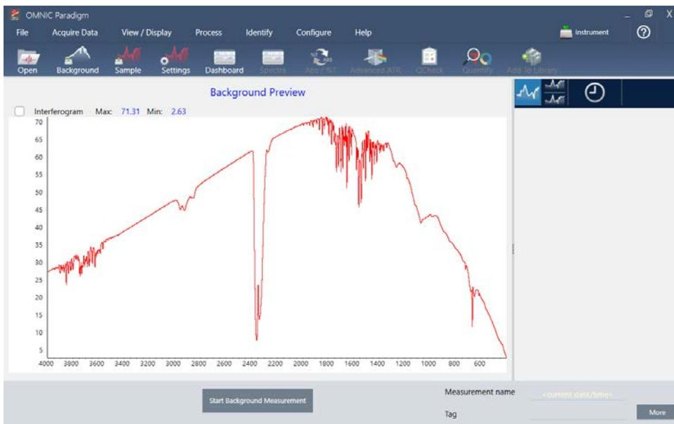
**Abbildung 3-2:** Hintergrundspektrum mit einem gespülten Transmissionszubehör
