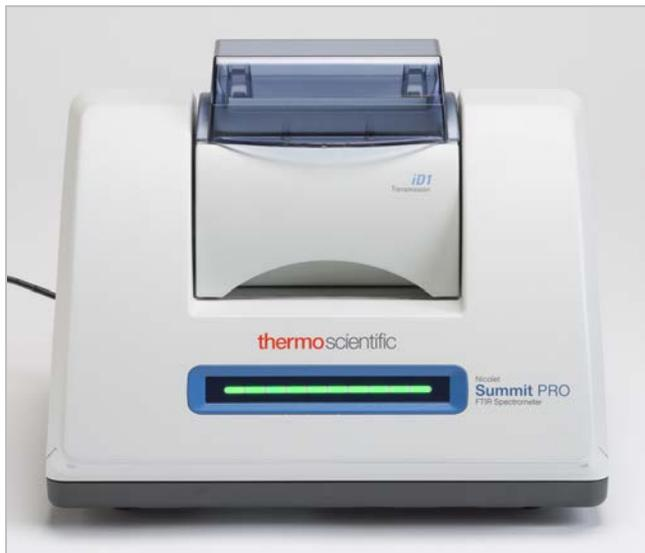
Entfernen Sie alle Proben von Ihrem Zubehör oder aus dem Probenhalter, damit das Spektrometer eine genaue Hintergrundmessung vornehmen kann, wenn es bereit ist. Die iD1-Zubehörabdeckung kann geöffnet oder geschlossen sein. (Wenn Ihr Transmissionszubehör mit trockener Luft oder Stickstoff gespült wird, halten Sie die Abdeckung geschlossen, es sei denn, Sie fügen eine Probe hinzu bzw. entnehmen sie).
