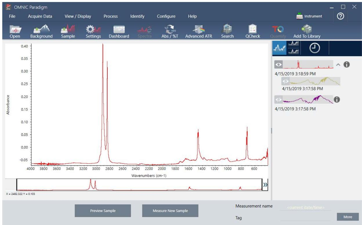
2. Stellen Sie sicher, dass das Spektrum im Spektralbereich ausgewählt ist, und führen Sie dann die gewünschten Verarbeitungs- oder Analyseschritte durch (z. B. Subtraktion, Basislinienkorrektur, Korrelationsuche usw.).
