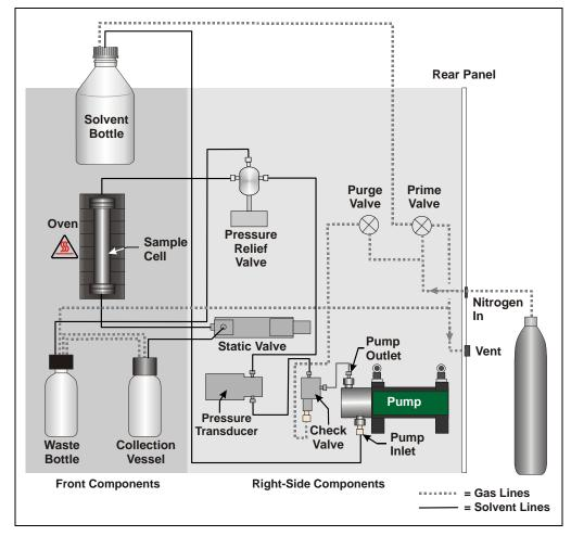
Figure 4-1. Dionex ASE 150 Plumbing Diagram
