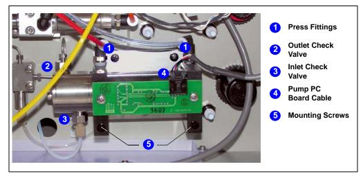
Figure 5-7. Dionex ASE 150 Pump (Behind Right-Side Panel)
