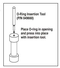
Figure 3-9. Installing a Cell End Cap O-Ring
