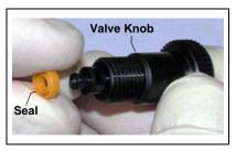
Figure 5-9. Waste Valve Seal Replacement
