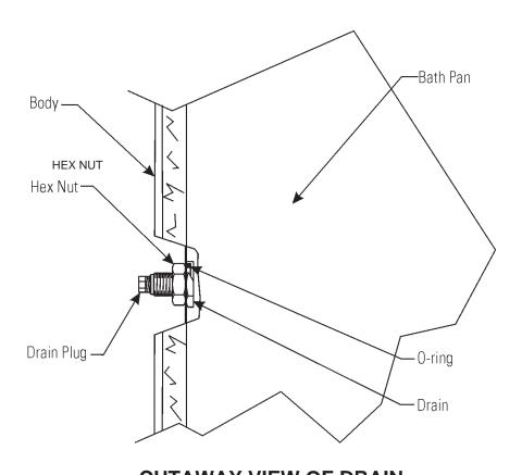
**CUTAWAY VIEW OF DRAIN**
