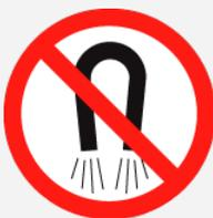
Pericolo di lesioni oculari. Tenere i magneti lontano dallo strumento in quanto possono eludere gli interblocchi causando emissioni di radiazioni visibili e/o invisibili quando si aprono le porte.
