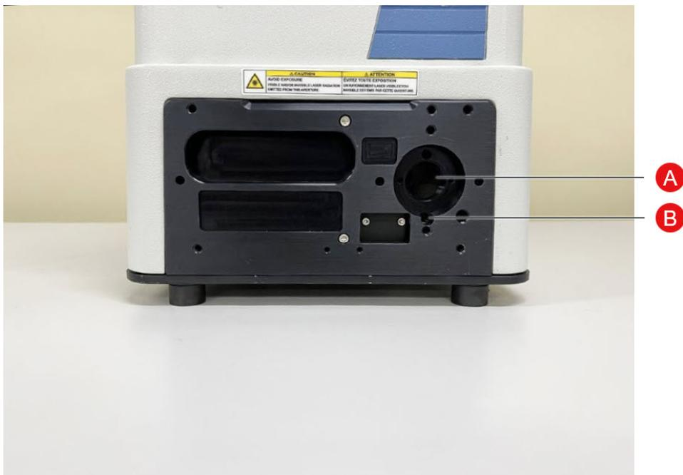
A : ouverture de sortie du laser lorsque l'accessoire à fibres optiques n'est pas utilisé.
