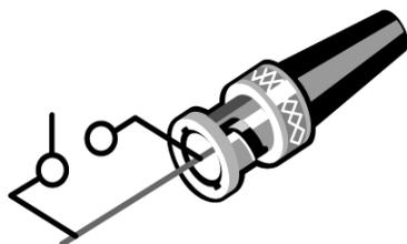
**Remarque** L'ouverture de l'interrupteur bloque le faisceau laser, tandis que sa fermeture libère le faisceau.
