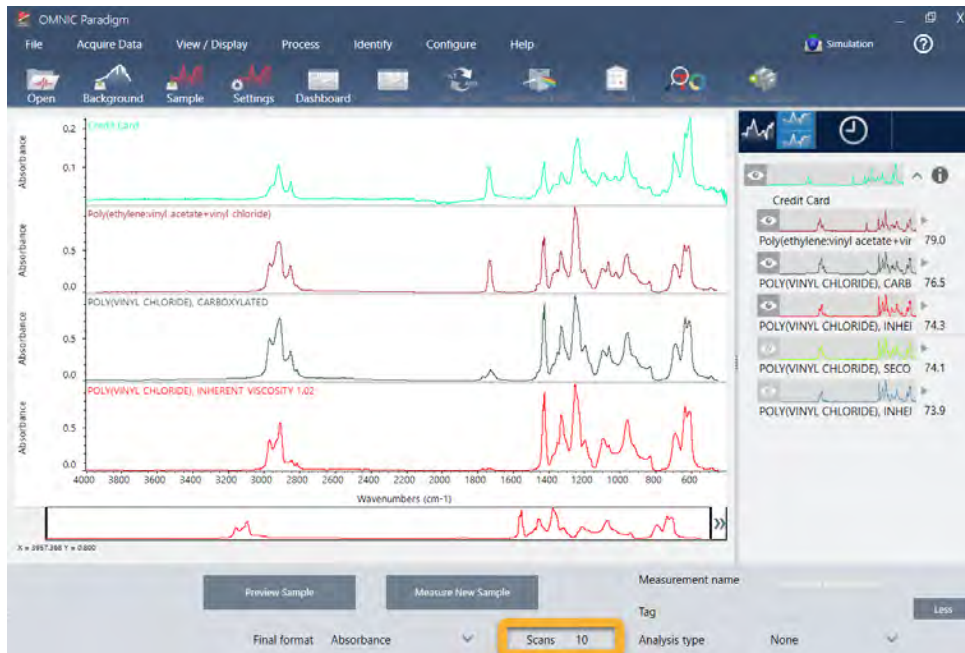
Figura 3-9: Resultados de búsqueda con los parámetros de medición modificables a la vista
