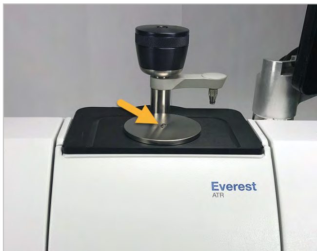
Figura 3-1: Medir un líquido con ATR
