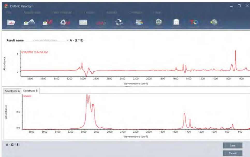
L'anteprima del risultato visualizza lo spettro risultante dall'equazione e ogni spettro utilizzato nell'equazione. Il risultato è mostrato nel riquadro superiore e gli spettri di riferimento in quello inferiore.
