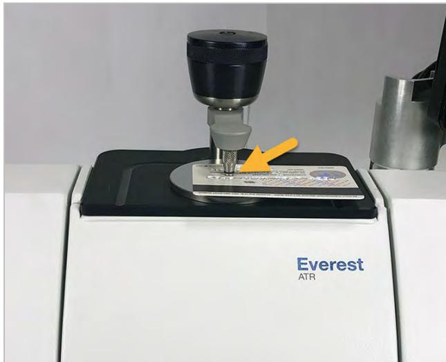
Una volta posizionato un campione, fare clic su **Preview Sample (Anteprima campione)** per visualizzare in anteprima i dati del campione nel riquadro spettrale. Se i picchi nello spettro dell'anteprima sono molto piccoli, usare un campione liquido più concentrato. Se si esegue la misurazione di un solido, riposizionare il campione sul cristallo ATR e riapplicare pressione.
