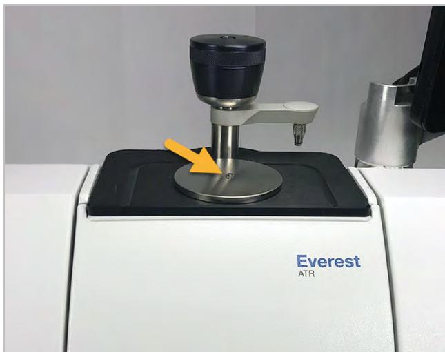
Per un campione solido, ruotare in senso antiorario la manopola sulla torre della pressione per sollevare il braccio. Quindi collocare il campione sul cristallo e ruotare in senso orario la manopola per abbassare il braccio. Continuare a ruotare la manopola finché non si percepisce lo scatto (clic). Per questa dimostrazione, misuriamo una tessera di plastica.
