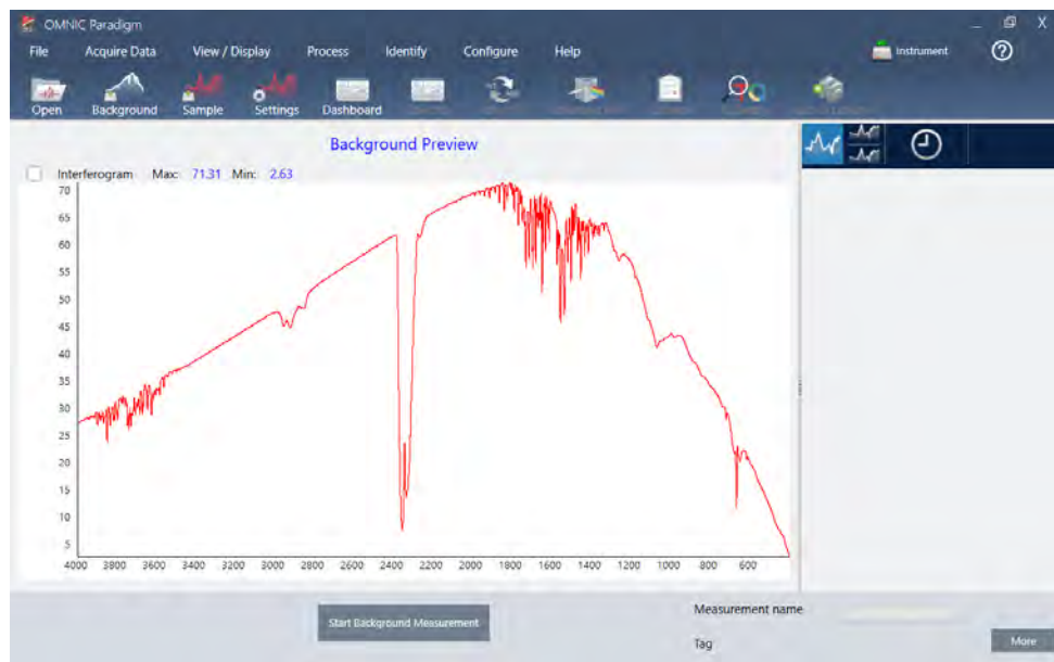
图 3-2: 来自已吹扫的透射附件的背景谱图
