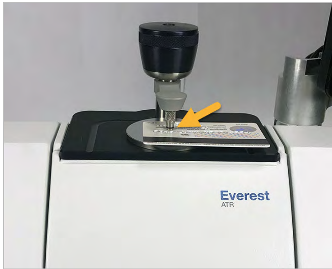
图 3-2: 使用 ATR 测量固体
