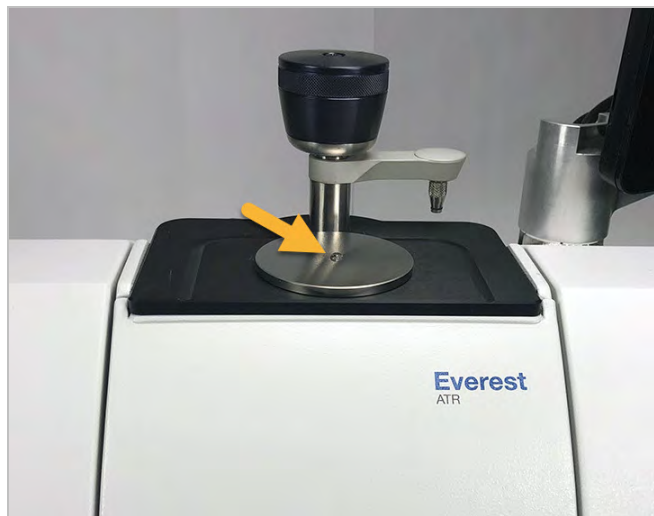
图 3-1: 使用 ATR 测量液体
