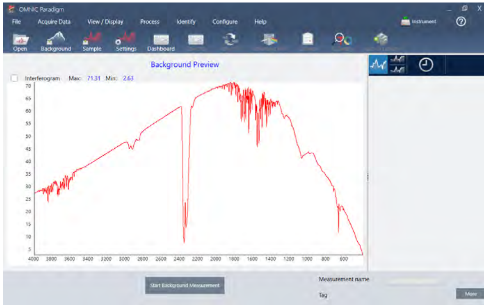
그림 3-2: 퍼징된 전송 부속품의 배경 스펙트럼
