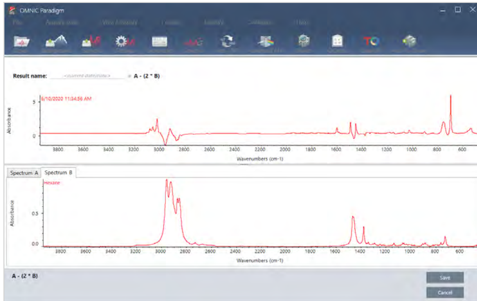
図4-2: 方程式の結果は上部に示され、リファレンスペクトルは下部に示されます
