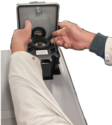
Abbildung 3-4: Anheben/Einsetzen eines Detektors
