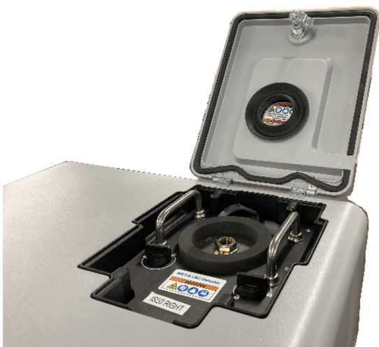
Abbildung 3-9: Verriegelung: verriegelte und entriegelte Position
