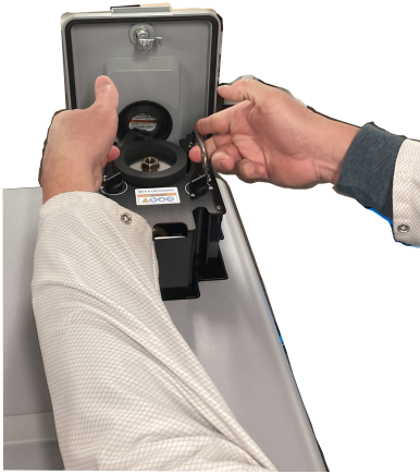
Abbildung 3-11: Anheben/Einsetzen eines Detektors
