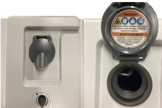
Abbildung 3-7: Einfüllöffnung des Dewargefäßes (geschlossen, offen)
