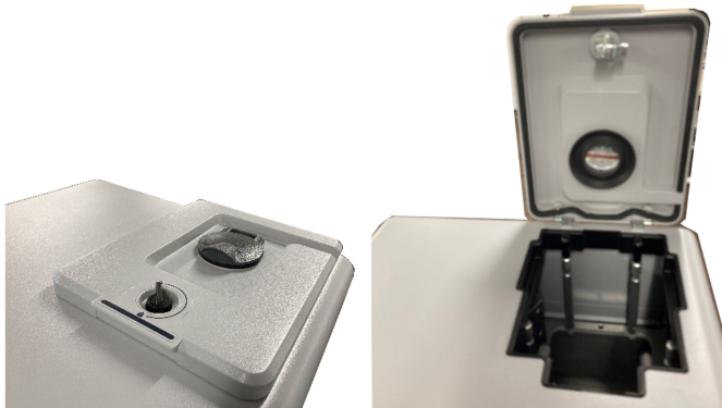
Abbildung 3-2: Verriegelung: verriegelte und entriegelte Position
