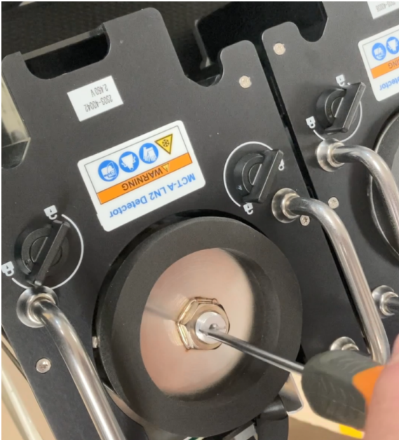
Figura 4-1: Reinstalación del dispositivo de fijación más grande
