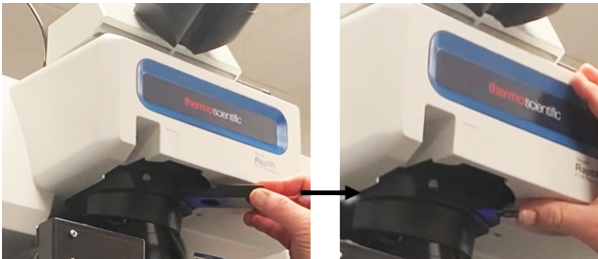
Figure 3-3 : Insérez le prisme de Wollaston dans la fente de la partie nasale
