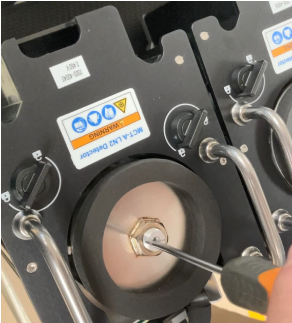
Figure 4-1 : Réinstallation de la plus grande pièce de retenue
