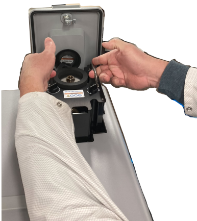
Figure 3-4 : Levage / insertion d'un détecteur
