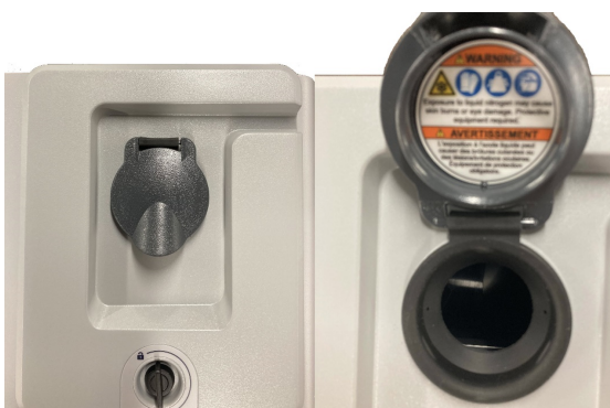
Рис. 3-7: Клапан заполнения сосуда Дьюара (закрытый, открытый)
