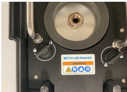
Рис. 3-10: Защелки детектора в разблокированном положении
