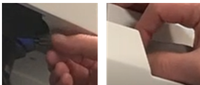
Рис. 3-4: Вращение призм Волластона
