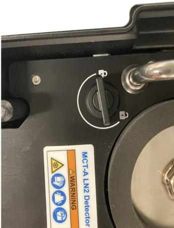
4. 关闭顶部舱盖并将主闩锁转到“锁定”位置。
