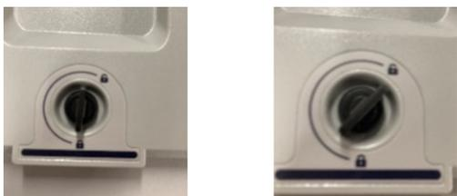
2. 在里面, 将检测器上的两个较小门锁转到“解锁”位置。
