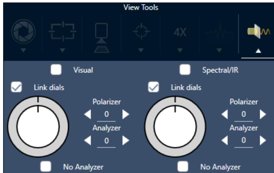
4. 选择 **Visual (视觉)** 可使用可见光偏振器。选择 **Spectral/IR (光谱/IR)** 可使用 IR 偏振器。
