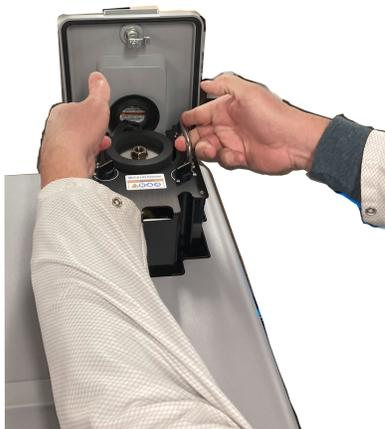
4. 关闭 RaptIR+ 显微镜的顶部舱盖(或插入新的检测器), 然后将主门锁转到“锁定”位置。
