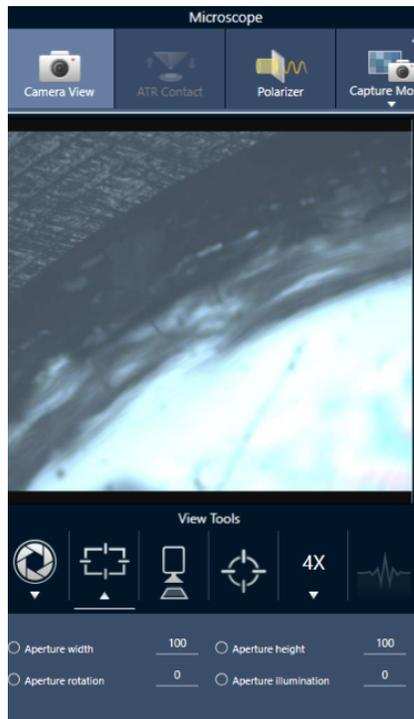
2. 使用滑块或输入精确值来调整光阑的高度、宽度和旋转。
