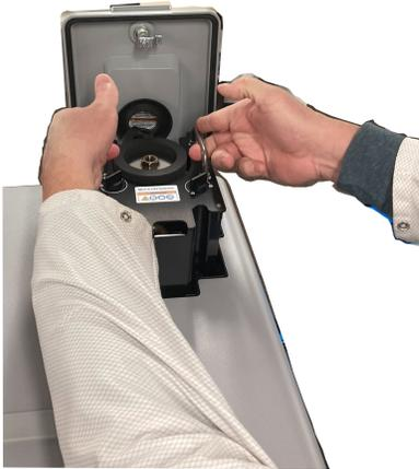
3. 在检测器就位后, 将两个较小的闩锁转到“锁定”位置, 直到将检测器固定在装置上。
