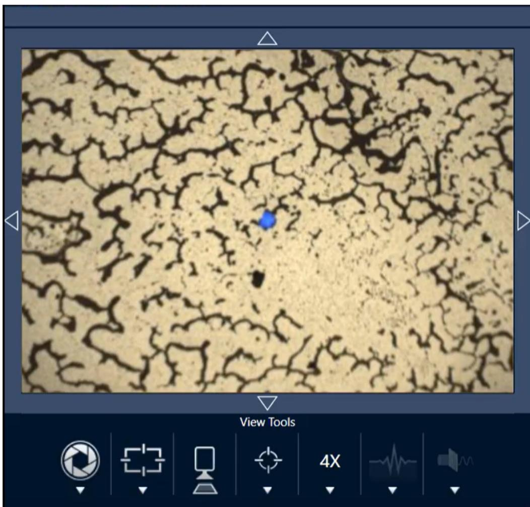
2. 将目标居中后, 选择 **Change Objective(更改物镜)** 切换到 15x 物镜。您将看到更明亮的样品和相关点图像。
