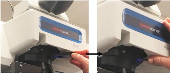
5. 将 DIC 光学组件插入显微镜会使样品图像变暗。要解决此问题, 请在软件中增加照明(建议将其调高至 5)。
