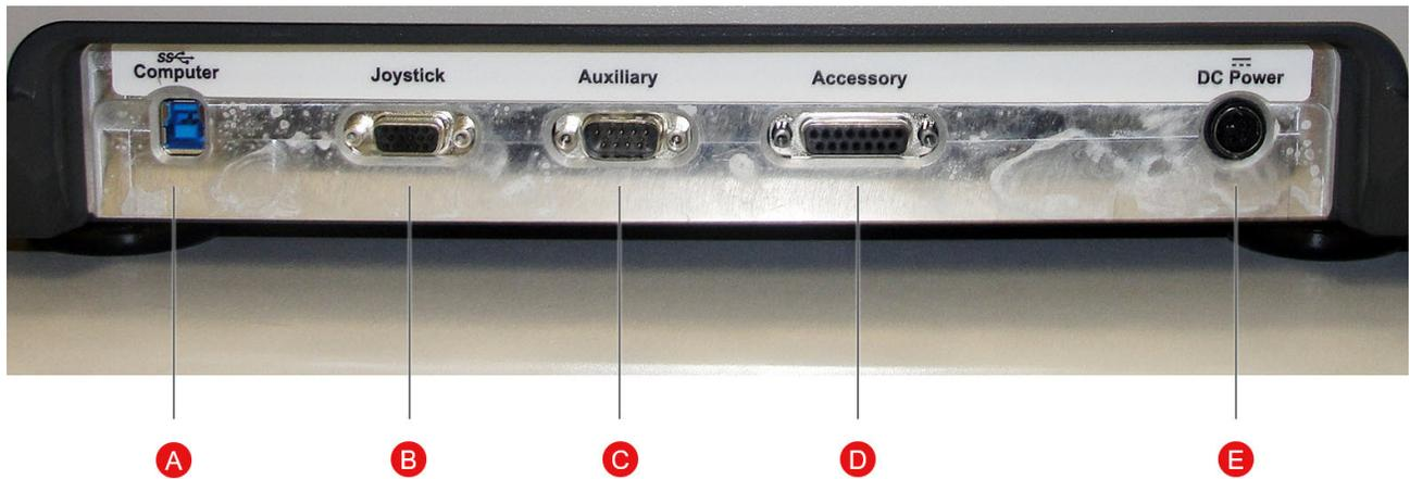
**A**            **USB 3.0 连接到计算机的 USB 3.0 端口**
