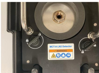
3. 通过把手提起检测器, 将其从插座中取出, 然后将其放置在平坦、光滑且静止表面上的安全位置。
