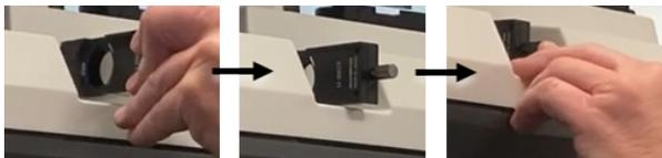
4. 松开显微镜物镜转换器指旋螺钉。这将允许第二个沃拉斯顿棱镜滑动通过凹槽。将棱镜滑入物镜转换器 (凹槽面朝上) 直到停止, 然后轻轻拧紧指旋螺钉固定棱镜。
