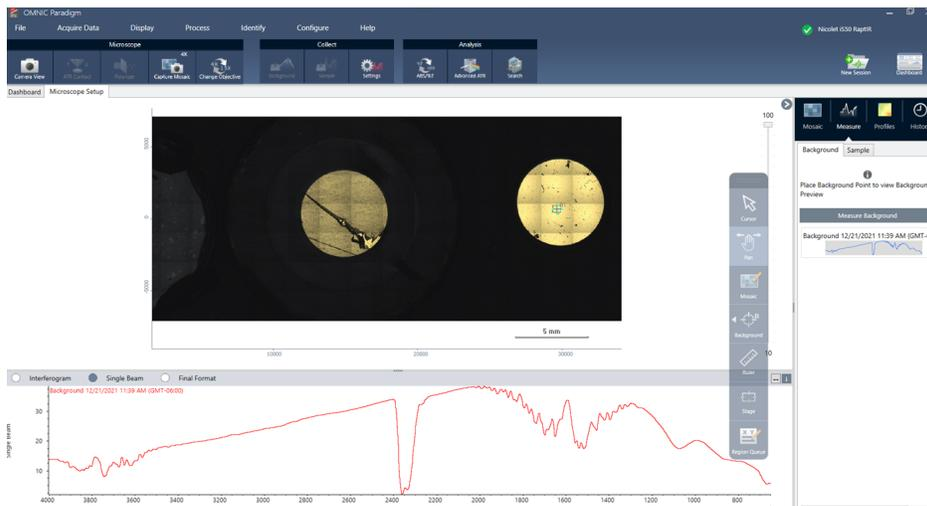
如果您在一段时间内测量多个区域, 请定期更换背景测量。通常, 在测量样品之前, 您应该始终对背景进行最近的测量。
