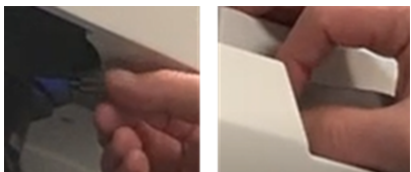
図3-4: ウォラストンプリズムの回転
