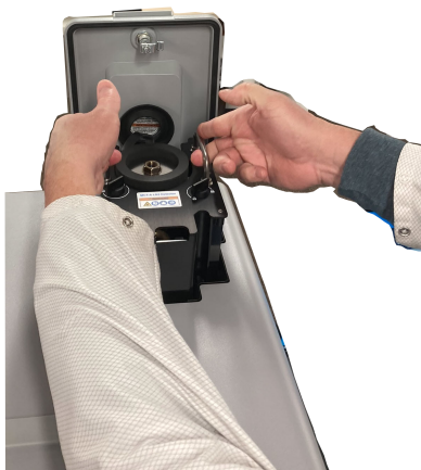
図3-4: 検出器を持ち上げる / 挿入する
