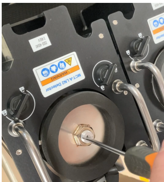
図4-1: 大きい方の固定具の再取り付け
