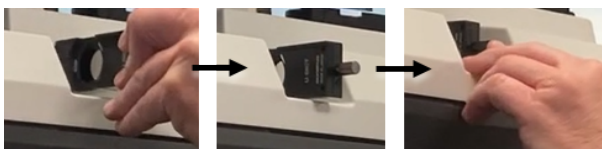
Rysunek 3-2: Wkładanie pryzmatu Wollastona do gniazda podstawy
