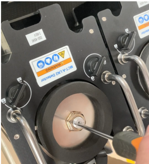
Rysunek 4-1: Ponowny montaż większego zabezpieczenia
