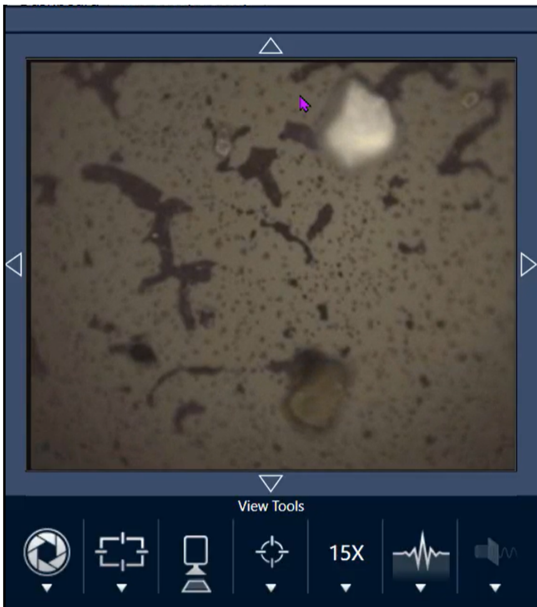
Rysunek 3-5: Obraz wybarwionych kuleczek polistyrenowych uzyskany przy użyciu obiektywu 15x (przy zamkniętej osłonie)
