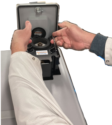
Rysunek 3-11: Podnoszenie/wprowadzanie detektora
