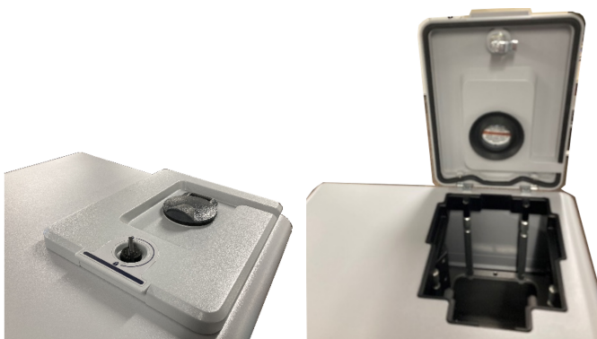
Rysunek 3-2: Zatrzask; pozycja zablokowania i odblokowania
