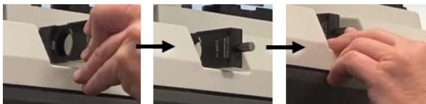
Figure 3-2 : Insérez le prisme de Wollaston dans la fente de la base
