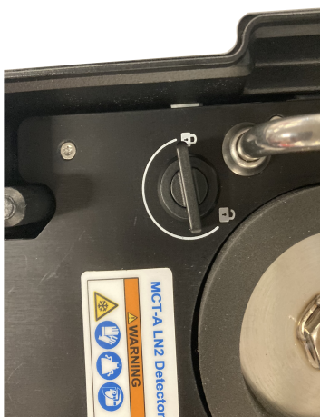
Figure 3-5 : Loquet du détecteur
