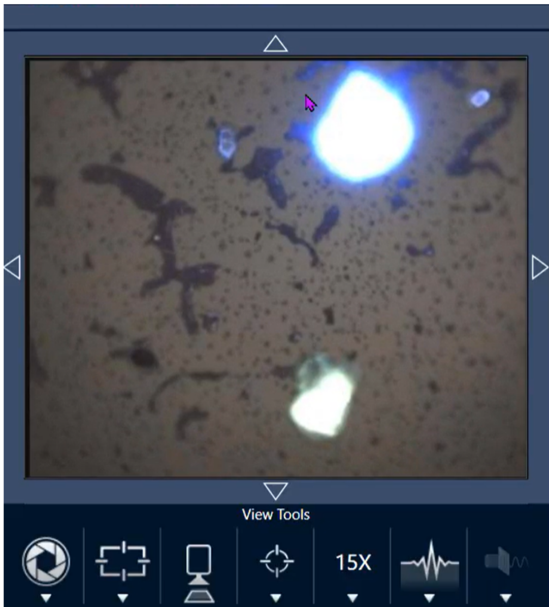
Figure 3-4 : Échantillon centré (billes de polystyrène teintées) à l'aide d'un objectif 15x.
