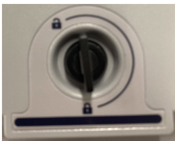
Figure 3-6 : Loquet supérieur (verrouillé)
