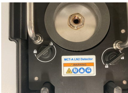
Figure 3-10 : Loquets de détecteur déverrouillés
