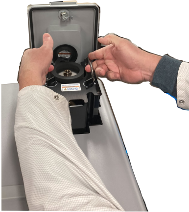
Figure 3-11 : Levage / insertion d'un détecteur
