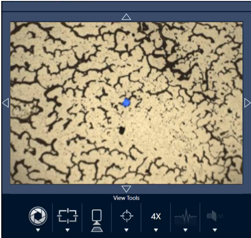
Figura 3-2: Muestra centrada (microesferas de poliestireno fluorescentes teñidas) con un objetivo de 4 aumentos y excitación azul; se observa la fluorescencia de una microesfera
