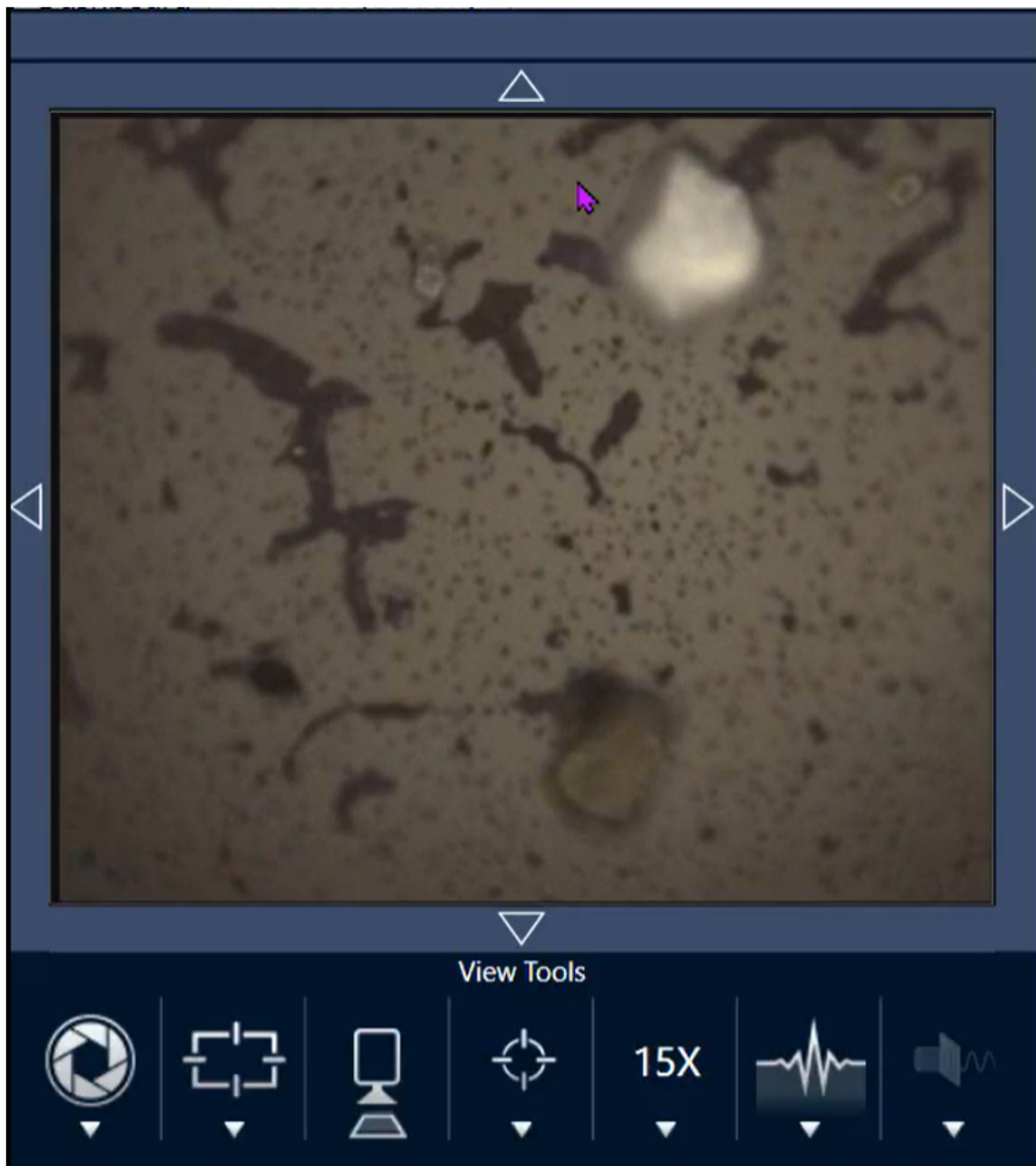
Рис. 3-5: Окрашенные полистироловые гранулы с использованием 15-кратного объектива (при закрытом затворе)
