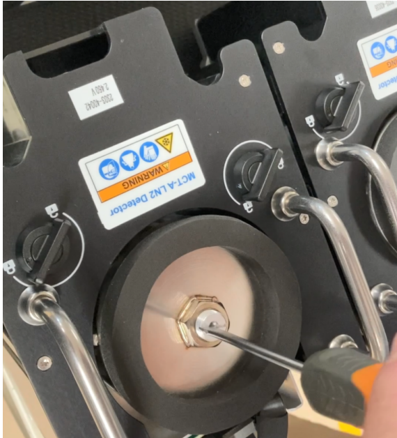
Рис. 4-1: Установка большого ограничителя
