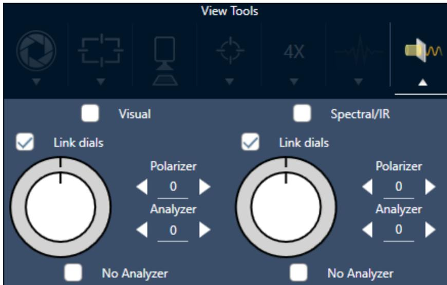
4. Wählen Sie **Visual (Sichtbar)**, um den Polarisator für sichtbares Licht zu verwenden. Wählen Sie **Spektral/IR**, um den IR-Polarisator zu verwenden.
