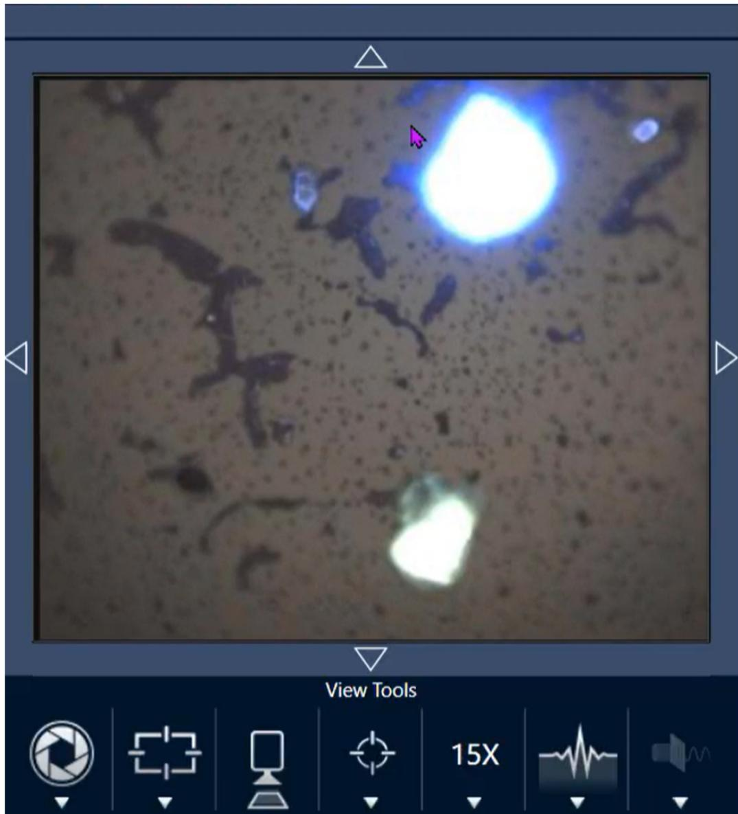
Das Bead in dem Beispiel ist jetzt deutlich heller. Die Fluoreszenzbeleuchtung wurde nicht verändert. Ein zweites in der Nähe befindliches Bead ist jetzt ebenfalls sichtbar.
