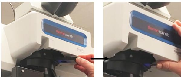
5. Durch das Einsetzen der DIC-Optik in das Mikroskop wird das Probenbild verdunkelt. Um dies zu beheben, verstärken Sie die Beleuchtung in der Software (es wird empfohlen, den Wert auf bis zu 5 zu erhöhen).
