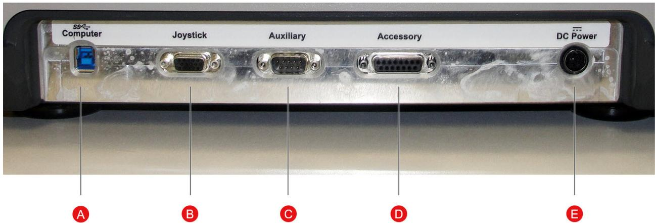
**A** USB-3.0-Anschluss für den Anschluss an den USB-3.0-Anschluss des Computers
