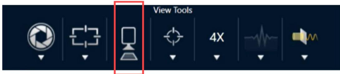
3. Wählen Sie **Change Objective (Objektiv wechseln)**, um zum 15x-Objektiv zu wechseln.
