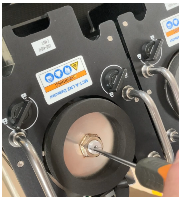
图 4-1: 重新安装较大的固定装置
