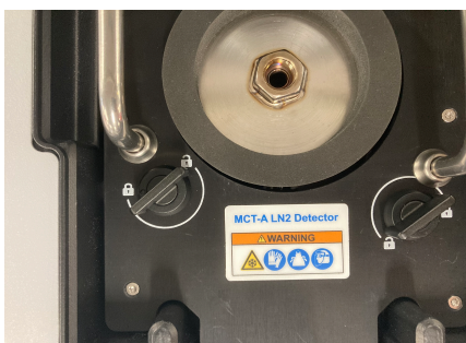
图 3-10: 解锁的检测器门锁
