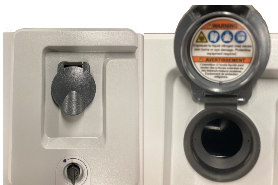
图 3-7: 杜瓦瓶加注口(关闭和打开状态)
