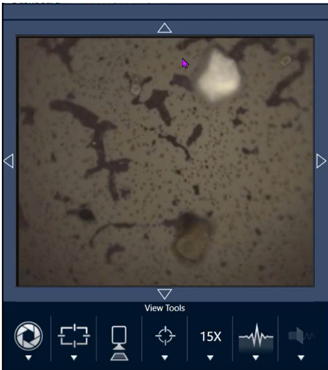
图 3-5: 使用 15x 物镜时的染色聚苯乙烯微珠(快门已关闭)
