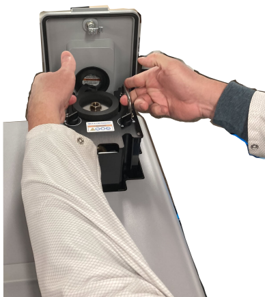
图 3-11: 提起/插入检测器
