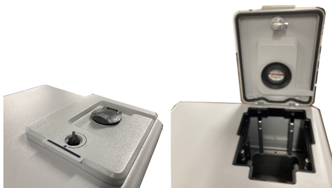
图 3-2: 闩锁: 锁定位置和解锁位置
