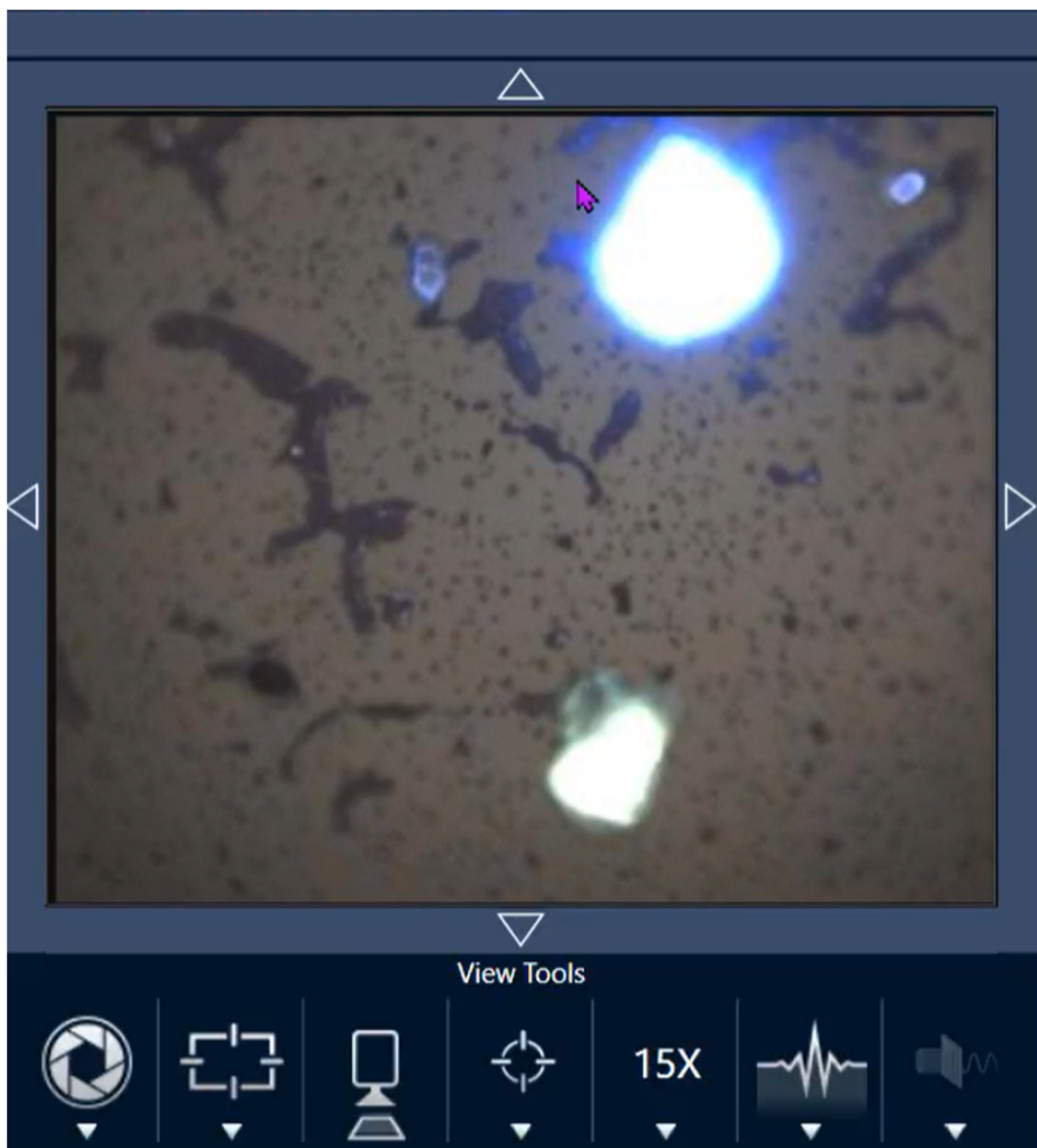
图 3-4: 使用 15x 物镜时的居中样品(染色聚苯乙烯微珠)。
