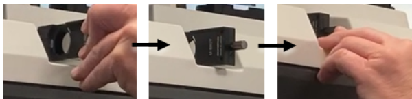
图 3-2: 将沃拉斯顿棱镜插入基座插槽
