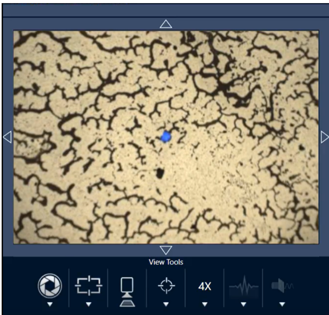
图 3-2: 使用 4x 物镜和蓝色激发时的居中样品(染色荧光聚苯乙烯微珠)。可以看到一颗微珠发出荧光。
