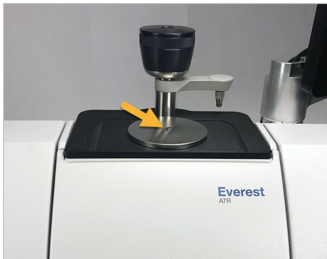
Abbildung 3-1: Messen einer Flüssigkeit mit ATR
