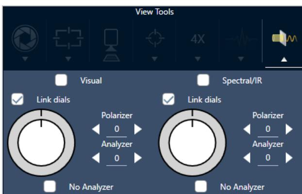
4. Selezionare Visual (Visuale) per usare il polarizzatore della luce visibile. Selezionare Spectral/IR (Spettrale/IR) per usare il polarizzatore dell'IR.
