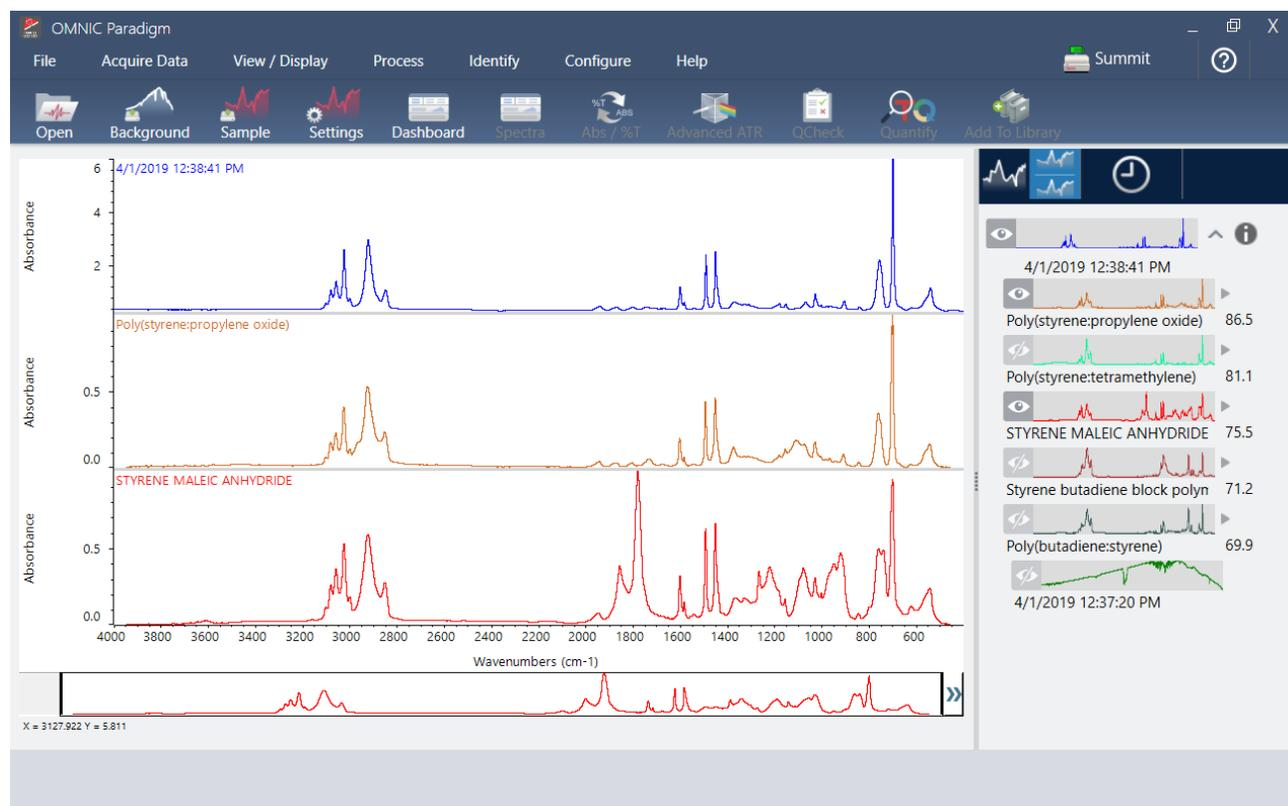
Usare la vista Spectra (Spettri) per elaborare, analizzare o esplorare i dati in modo approfondito. Essa permette di elaborare i dati, trovare e marcare i picchi nonché ottimizzare la vista per poter confrontare o analizzare più semplicemente gli spettri.
