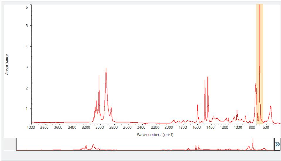
Questi picchi “piatti” sono denominati “totalmente assorbenti” e possono contenere un rumore spettrale eccessivo che influisce sui risultati dell’analisi. Per escludere un picco totalmente assorbente, aprire le impostazioni di ricerca, deselezionare Use full spectral range (Usa range spettrale completo) e specificare le regioni da cercare che escludono la regione totalmente assorbente.
