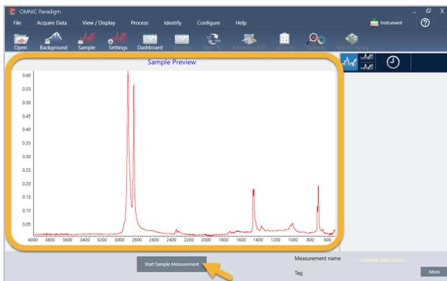
Se lo spettro non ha picchi del campione, controllare che il materiale del campione assorba energia nella regione dell'infrarosso dello spettro di luce. Se si osservano ulteriori picchi nello spettro, assicurarsi che il cristallo sia pulito.
