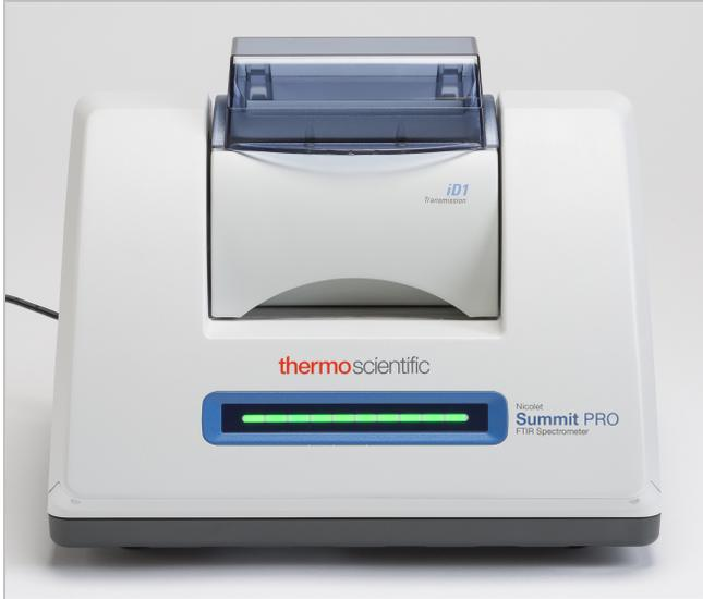
Rimuovere il campione dall'accessorio o dal supporto del campione in modo che lo spettrometro, quando è pronto, possa eseguire una misurazione del background accurata. Il coperchio dell'accessorio iD1 può essere aperto o chiuso. (Se l'accessorio di trasmissione è spurgato con aria secca o idrogeno, tenere chiuso il coperchio a meno che non si stia aggiungendo o rimuovendo un campione).
