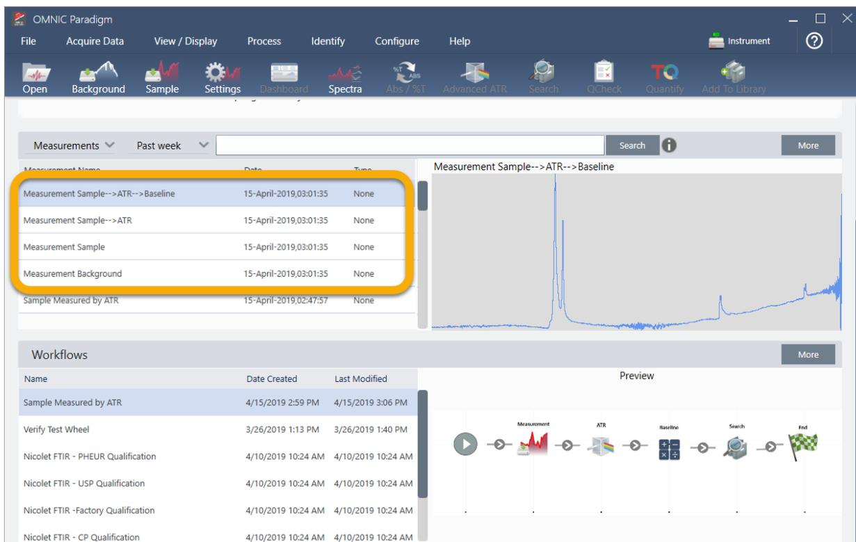
Il nostro workflow di esempio ha creato quattro spettri, lo spettro del background misurato, lo spettro del campione misurato, lo spettro del campione corretto con ATR e lo spettro del campione corretto con la linea di base con i risultati della ricerca. Gli spettri generati dal workflow sono denominati con le proprietà Tile Name (Nome riquadro) dei riquadri Workflow associati.
