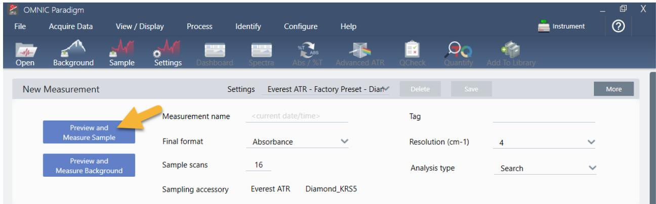
L'analisi inizia con una misurazione del background. L'unico requisito per un background ATR è quello di assicurarsi che il cristallo sia pulito. Lo spettro di background viene utilizzato per eliminare segnali nei dati del campione causati dallo spettrometro, dal cristallo ATR o dall'ambiente del background.
