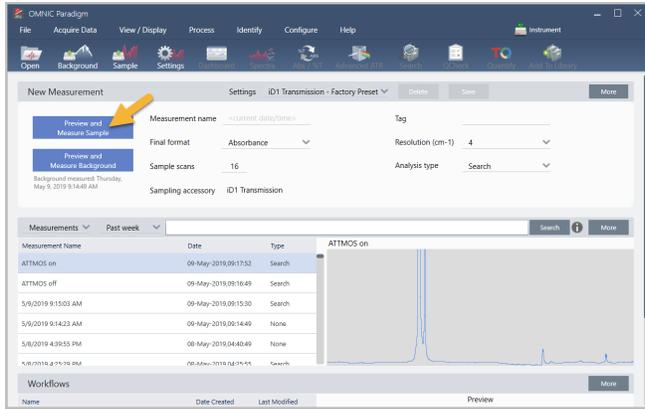
L'analisi inizia con una misurazione del background. L'unico requisito per un background di trasmissione consiste nel rimuovere tutti i campioni dal percorso del fascio infrarosso. Lo spettro di background viene utilizzato per eliminare i segnali nei dati del campione causati dallo spettrometro, dall'accessorio di trasmissione o dal supporto del campione o dall'ambiente di background.
