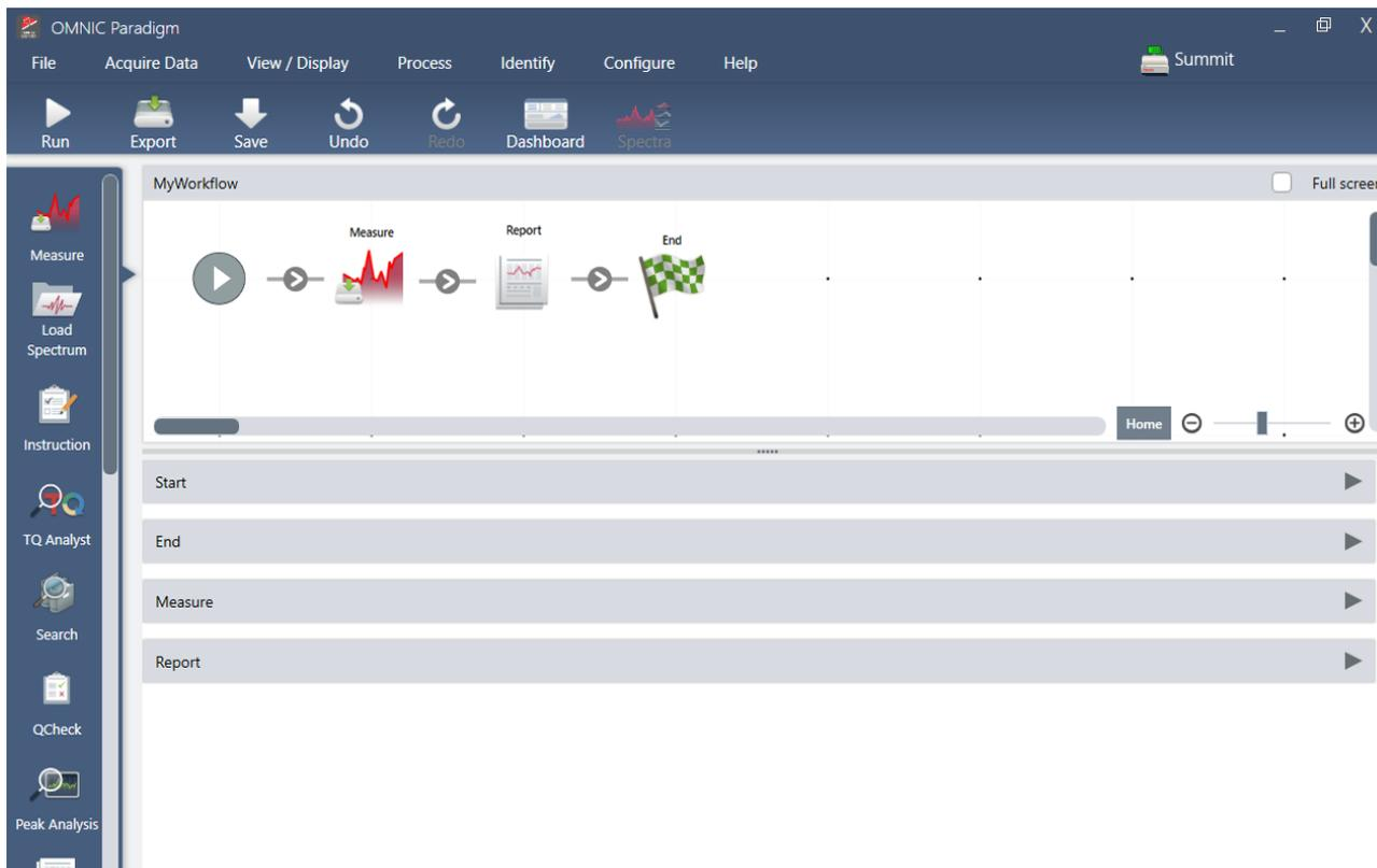
Automatizzare le attività con un workflow per assicurare che le misurazioni siano raccolte ed elaborate ogni volta esattamente allo stesso modo. Modificare o creare un workflow semplicemente trascinando i riquadri nell'Editor del workflow ed eseguire il workflow con il semplice clic di un pulsante.
