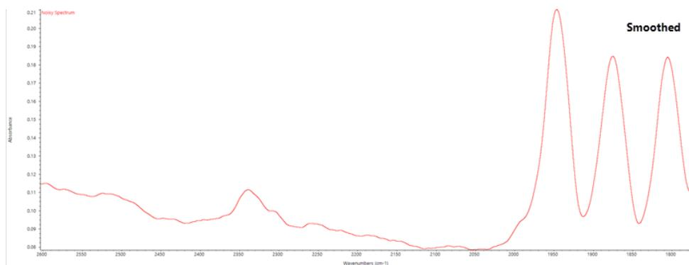
Prestare attenzione durante lo smoothing degli spettri con picchi del campione reale, più stretti, dato che vengono sottoposte a smoothing anche queste caratteristiche. Lo smoothing degrada la risoluzione spettrale effettiva dei dati e può rimuovere (“levigare”) le caratteristiche spettrali più piccole.
