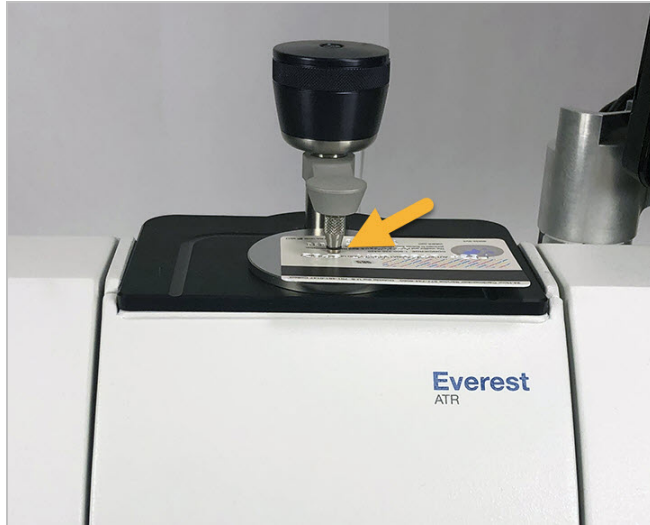
Figure 3-2 : mesure d'un solide avec la fonction ATR
