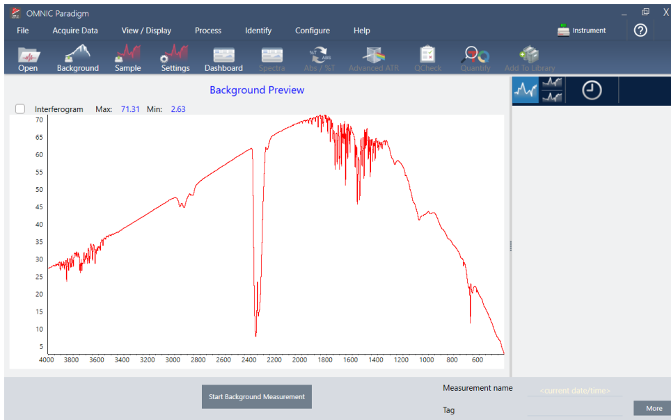
Figura 3-1: Spettro di background di un accessorio di trasmissione non spurgato
