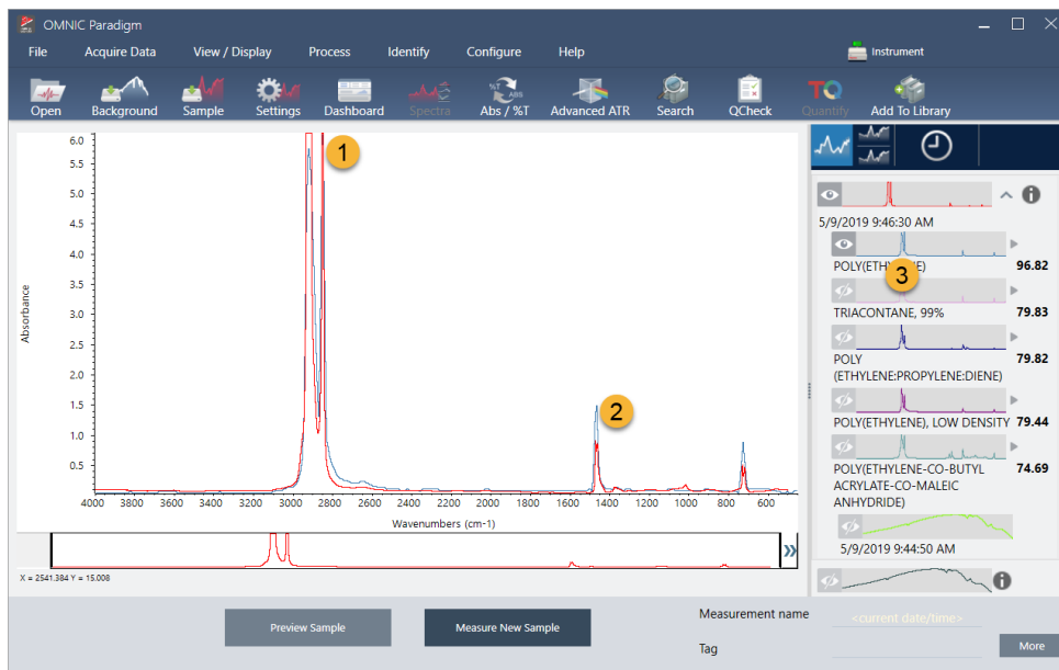
Figura 3-4: Risultato del campione e miglior risultato visualizzati assieme utilizzando la stessa scala dell'asse delle Y
