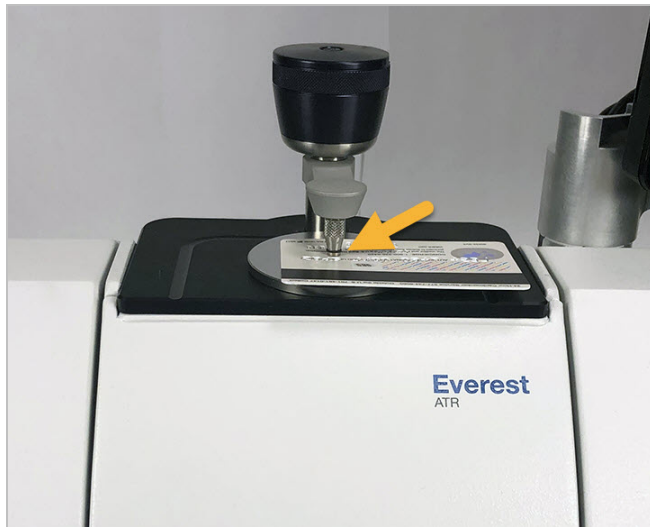
Figura 3-2: Misurazione di un solido con ATR
