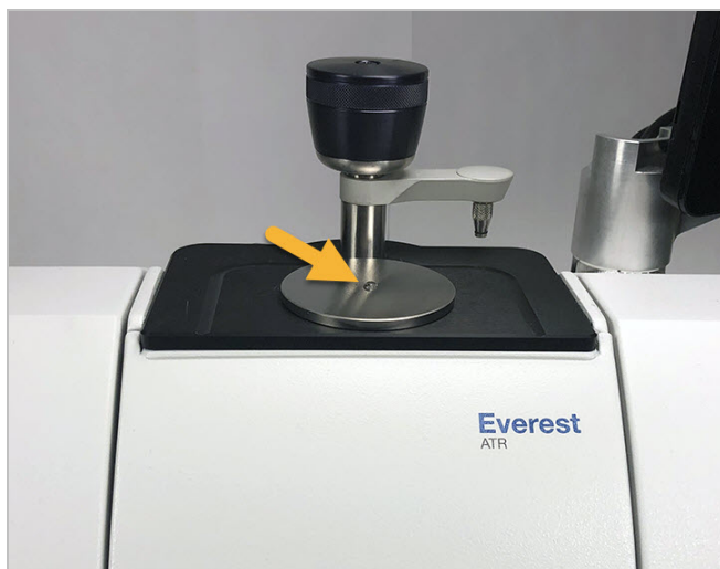
図3-1: ATRで液体を測定
