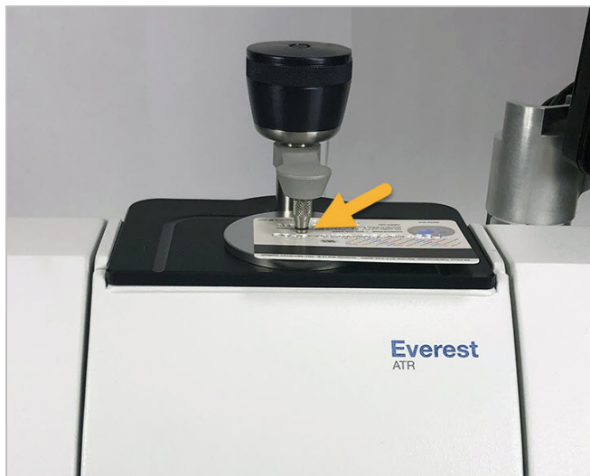
図3-2: ATRで固体を測定
