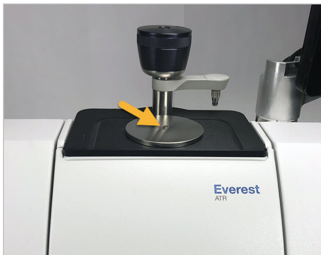
Figura 3-1: Medir un líquido con ATR
