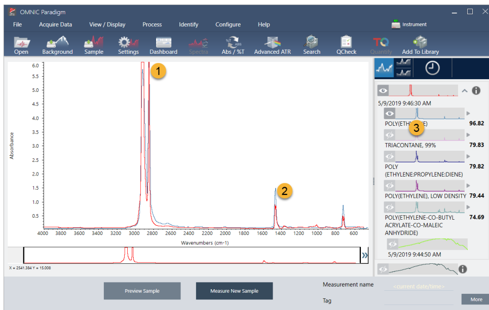
Figure 3-4 : résultats de recherche de l'échantillon et des meilleures correspondances affichés simultanément en utilisant la même échelle d'axe Y
