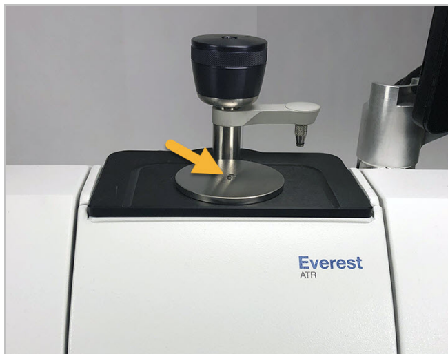
Figure 3-1 : mesure d'un liquide avec la fonction ATR
