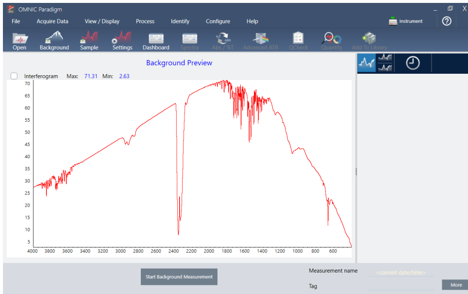
Figure 3-1 : spectre de bruit de fond d'un accessoire de transmission qui n'a pas été purgé
