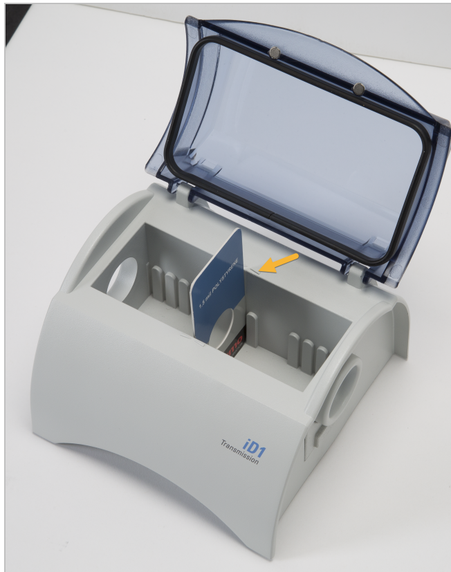
Abbildung 3-3: Brennpunkt des iD1-Transmissionszubehörs
