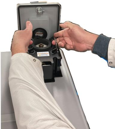
3. Wenn der Detektor eingesetzt ist, drehen Sie die beiden kleineren Verriegelungen in die verriegelte Position, um den Detektor auf dem Gerät zu fixieren.
