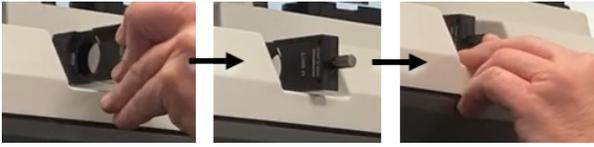
4. Lösen Sie die Rändelschraube des Objektivrevolvers des Mikroskops. Dadurch kann das zweite Wollaston-Prisma hinter die Einkerbungen geschoben werden. Schieben Sie das Prisma bis zum Anschlag in den Objektivrevolver (Einkerbungsseite nach oben), und fixieren Sie dann das Prisma, indem Sie die Rändelschraube vorsichtig drehen.
