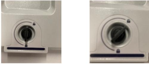
2. Drehen Sie im Inneren die beiden kleineren Verriegelungen am Detektor in die entriegelte Position.
