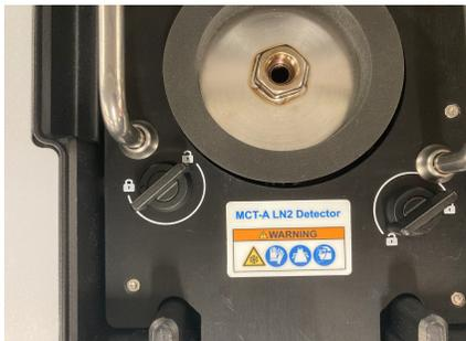
3. Heben Sie den Detektor an den Griffen aus der Aufnahme heraus und stellen Sie ihn an einem sicheren Ort auf eine flache, ebene und unbewegliche Oberfläche.
