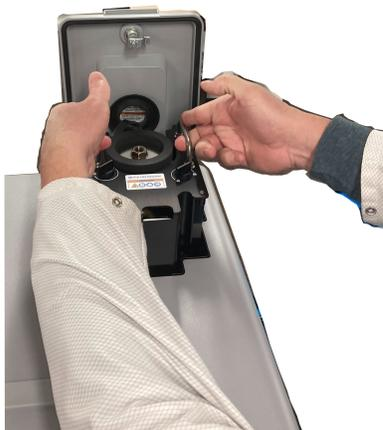
4. Schließen Sie die obere Klappe des RaptIR+-Mikroskops (oder setzen Sie einen neuen Detektor ein) und drehen Sie die Hauptverriegelung in die verriegelte Position.
