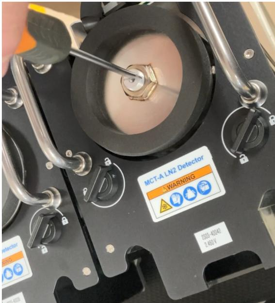
2. Setzen Sie die kleinere Transportsicherung in das Loch ein und ziehen Sie sie fest.
