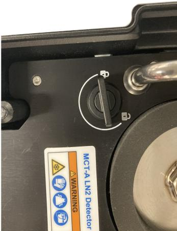
4. Schließen Sie die obere Klappe und drehen Sie die Hauptverriegelung in die verriegelte Position.
