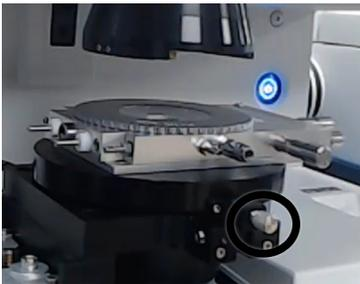
4. Konfigurieren Sie den Linkam-Tisch. Gehen Sie zu **Configure > Instrument > Microscope** (Konfigurieren > Instrument > Mikroskop) und wählen sie **RaptIR with Manual Stage** (RaptIR mit manuellem Tisch). Starten Sie die OMNIC Paradigm-Software neu.
