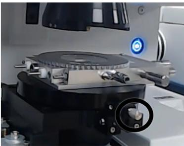
3. Entfernen Sie den Linkam-Tisch. Wenn dieser ausreichend gelockert ist, sollte er mit einem deutlichen Geräusch aus seiner Position springen. Wenn Sie den Tisch nicht entfernen können, drehen Sie den Knopf noch etwas weiter heraus.
