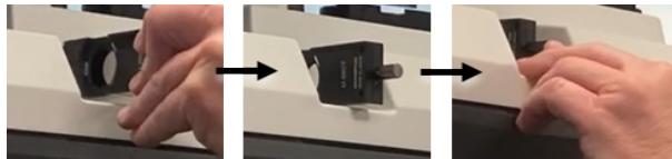
图 3-2：将沃拉斯顿棱镜插入基座插槽
