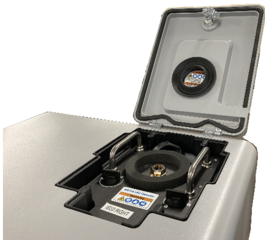
图 3-8：检测器在内部情况下打开门锁
