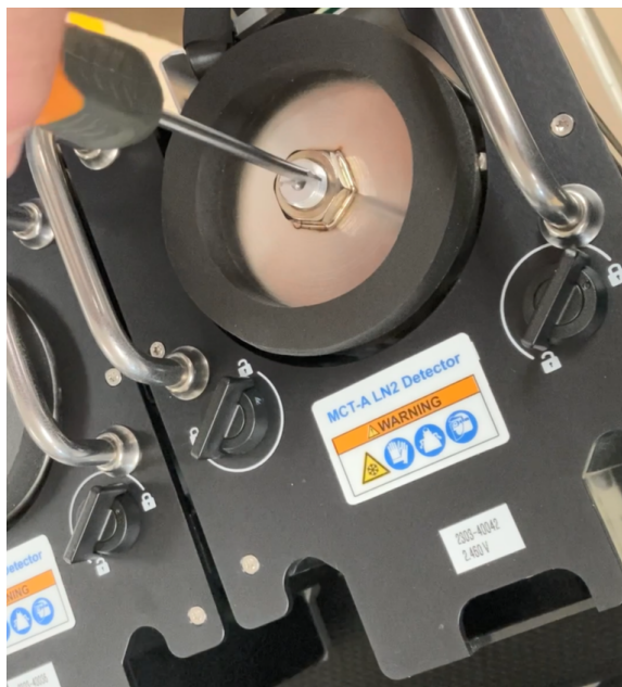
图 4-1：重新安装较大的固定装置
