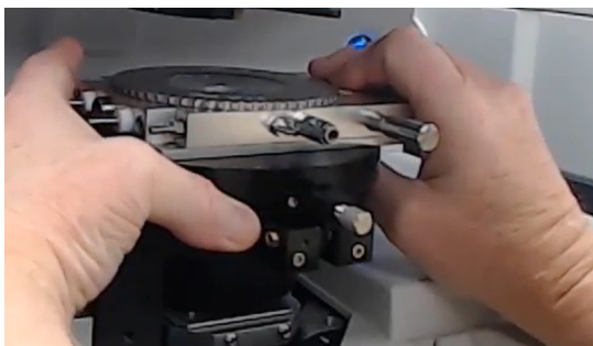
図 3-7: Linkamステージの取外し
