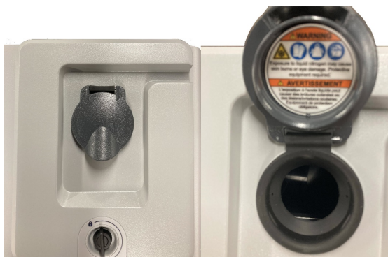
図 3-7: デュワーの注入口(閉じた状態、開いた状態)
