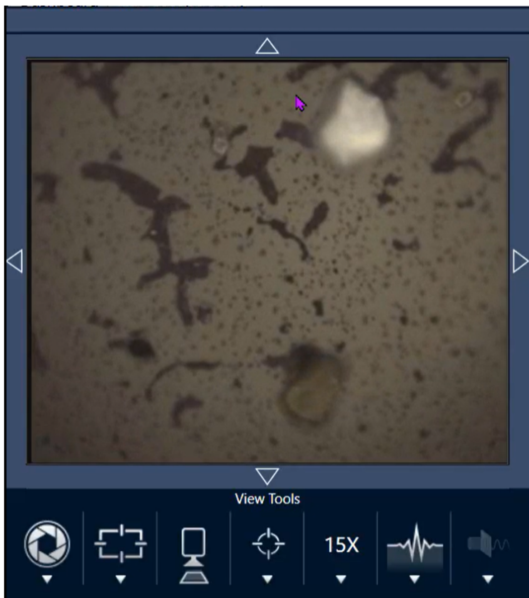
図 3-5: 15倍の対物レンズ使用時の染色されたポリスチレンビーズ(シャッター閉)
