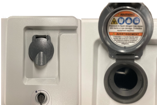
Figura 3-7: Puerto de llenado del recipiente Dewar (cerrado, abierto)
