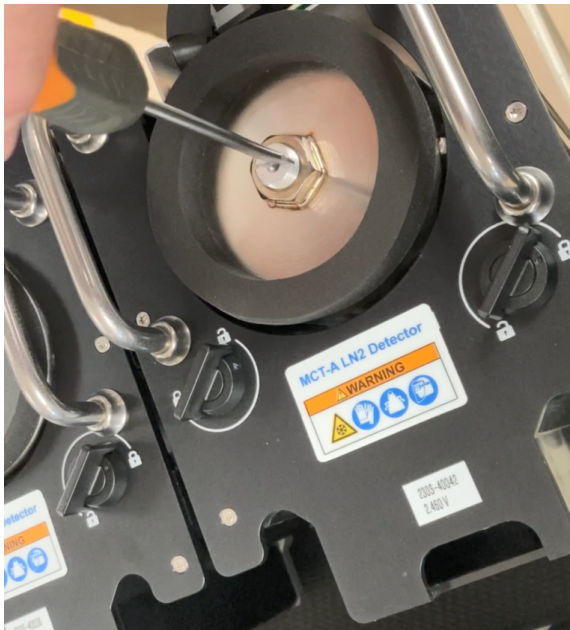
Figura 4-1: Reinstalación del dispositivo de fijación más grande
