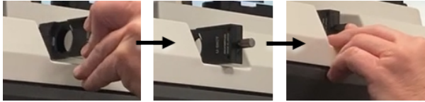
Рис. 3-2: Вставьте призму Волластона в гнездо у основания
