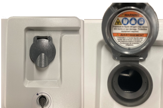
Рис. 3-7: Клапан заполнения сосуда Дьюара (закрытый, открытый)
