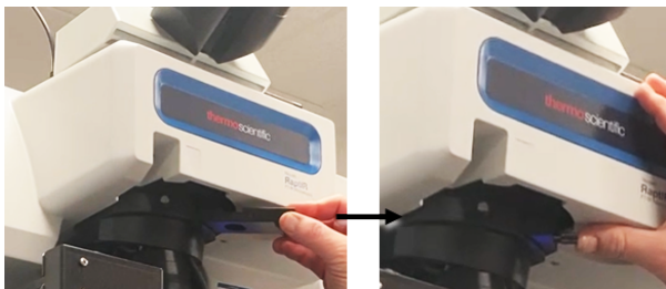
Рис. 3-3: Вставьте призму Волластона в гнездо на револьверной головке
