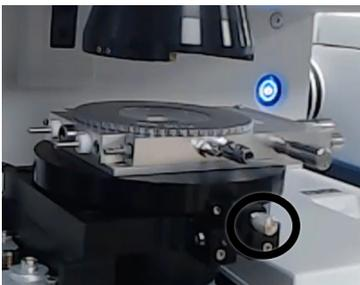
4. Configurez la platine Linkam. Accédez à **Configure > Instrument > Microscope (Configurer > Instrument > Microscope)** et sélectionnez **RaptIR with Manual Stage (RaptIR avec platine manuelle)**. Ensuite, redémarrez le logiciel OMNIC Paradigm.
