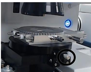
3. Retirez la platine Linkam. Si elle est suffisamment desserrée, elle devrait se déclipser en faisant un bruit. Si vous n'arrivez pas à retirer la platine, desserrez simplement le bouton un peu plus.
