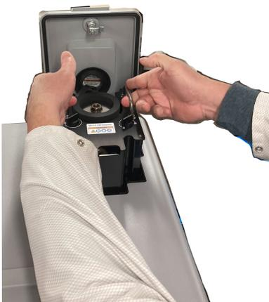
3. Lorsque le détecteur est en place, tournez les deux petits loquets en position “verrouillée” jusqu'à ce qu'ils soient bien serrés pour fixer le détecteur sur l'appareil.
