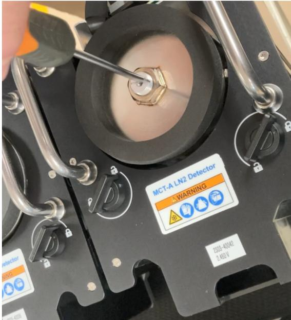
2. Insérez la plus petite pièce de retenue d'expédition dans le trou et vissez-la jusqu'à ce qu'elle soit bien ajustée.
