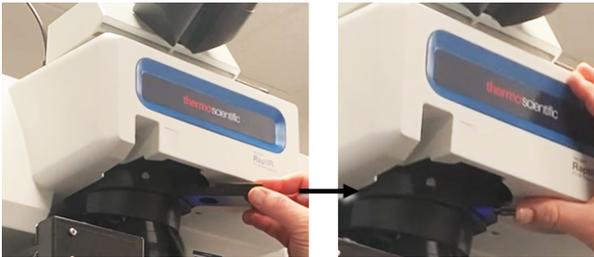
5. L'insertion de l'optique de DIC dans le microscope assombrit l'image de votre échantillon. Pour y remédier, augmentez l'éclairage dans le logiciel (le niveau 5 est recommandé).
