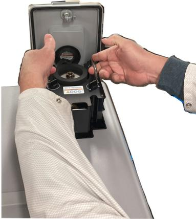
4. Fermez la trappe supérieure du microscope RaptIR + (ou insérez un nouveau détecteur), puis tournez le loquet principal en position "verrouillée".
