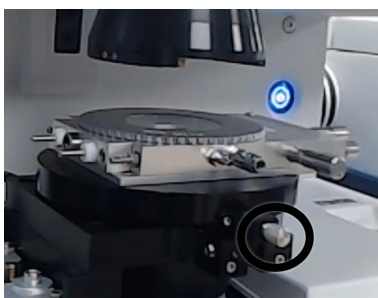
Rysunek 3-6: Przednie pokrętko stolika
