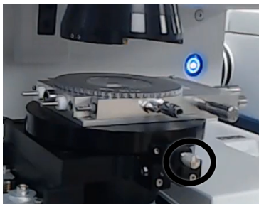
Rysunek 3-1: Przednie pokrętło stolika
