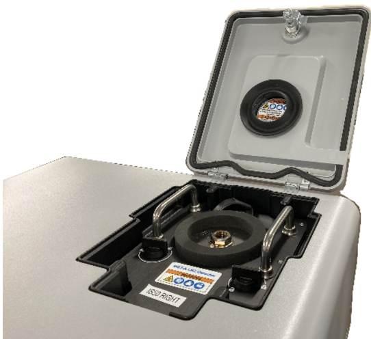
Rysunek 3-9: Zatrzask; pozycje zablokowania i odblokowania
