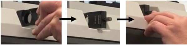
Rysunek 3-2: Wkładanie pryzmatu Wollastona do gniazda podstawy
