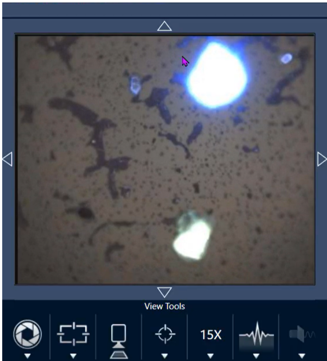
Rysunek 3-4: Wyśrodkowana próbka (wybarwione kuleczki polistyrenowe); obraz uzyskany przy użyciu obiektywu o powiększeniu 15x.
