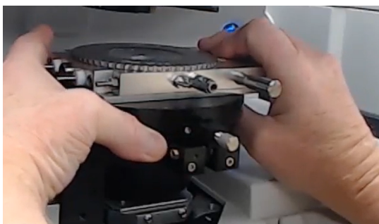
Rysunek 3-7: Zdejmowanie stołu Linkam
