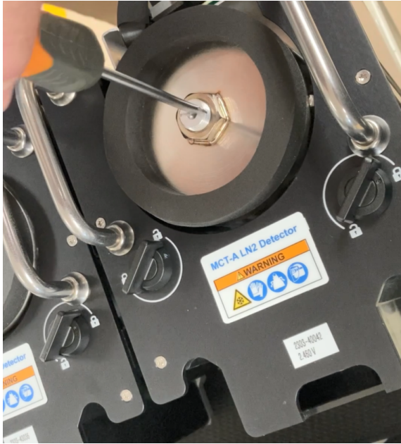
Rysunek 4-1: Ponowny montaż większego zabezpieczenia
