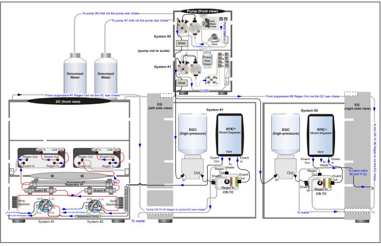
Figure 3-6. Analytical IC: Dual RFIC-EG System (CD/CD)
