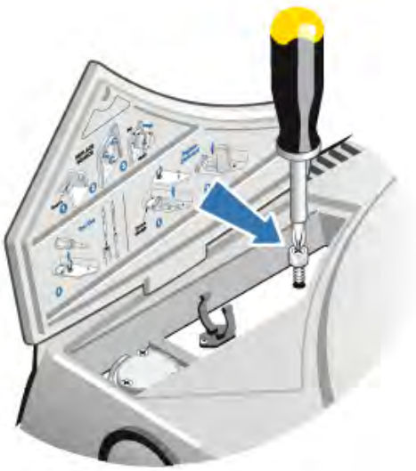
Figura 5-1: Rimozione della piastra del materiale essiccante
