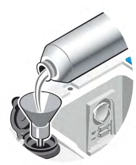
Figura 3-2: Riempimento del dewar del rivelatore
