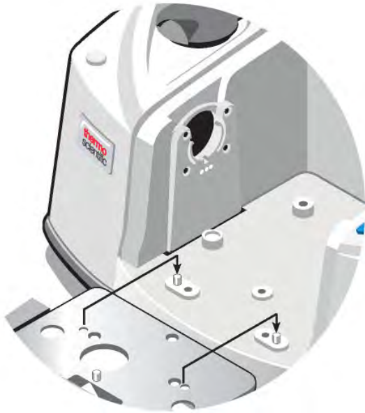
Figura 4-1: Pasadores del kit de ampliación del compartimento de muestras
