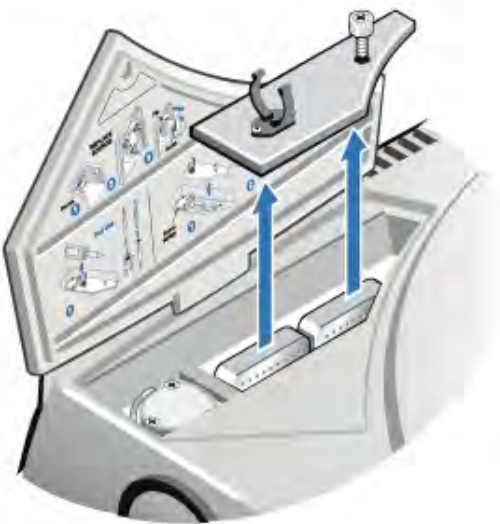
Figura 5-2: Retirar la cubierta del desecante
