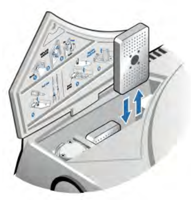
Abbildung 5-3: Entnehmen der Trockenmittelabdeckung
