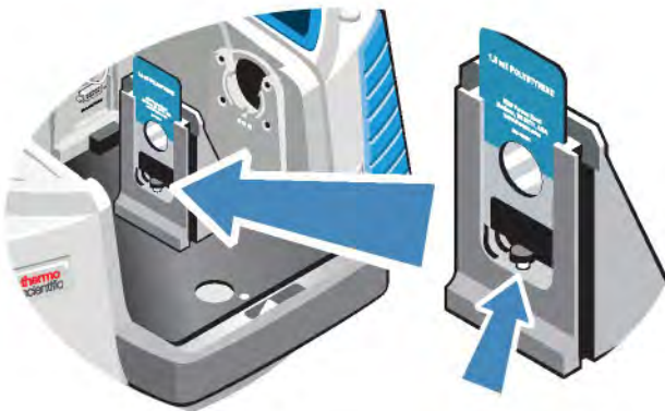
Figura 4-2: Regolare l'altezza del campione
