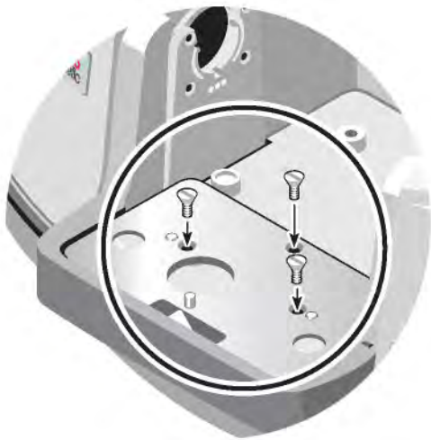
Abbildung 4-2: Anbringen der Schrauben für Probenraumerweiterung
