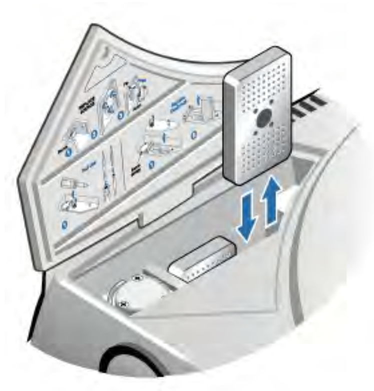
Figura 5-3: Levantar la cubierta del desecante
