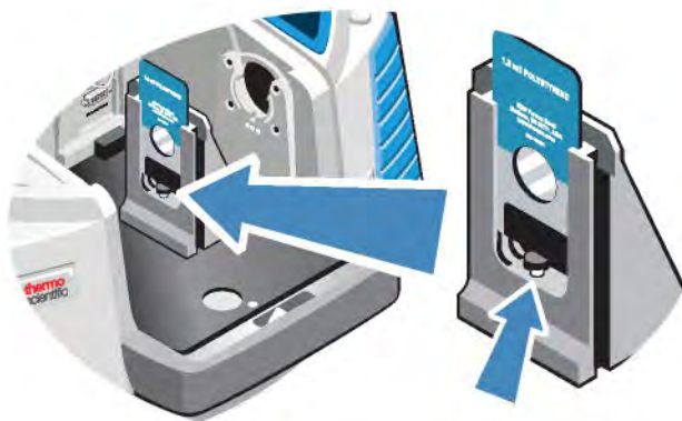
Figure 4-2 : Ajustez la hauteur des échantillons
