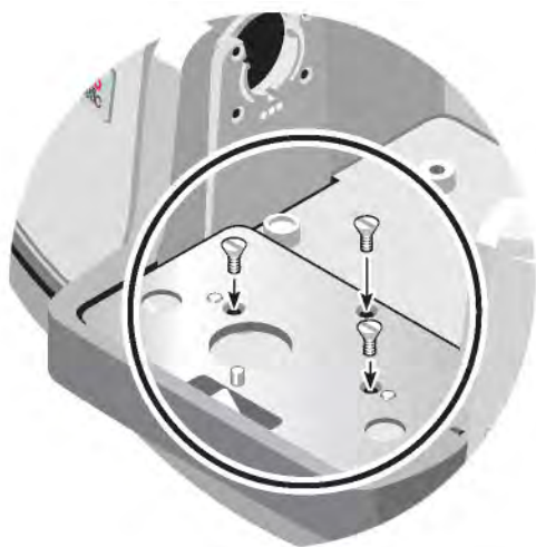
Figure 4-2 : Installation du kit d'extension du compartiment à échantillons
