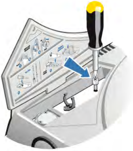
Figura 5-2: Retirar la cubierta del desecante
