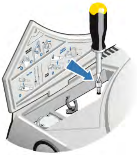
图 5-1:取下干燥剂板
