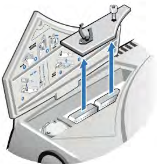
Abbildung 5-2: Entfernen der Trockenmittelabdeckung
