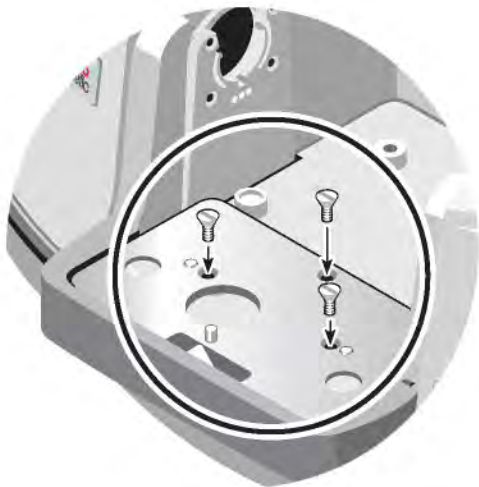
Figura 4-2: Colocación de los tornillos del kit de ampliación del compartimento de muestras
