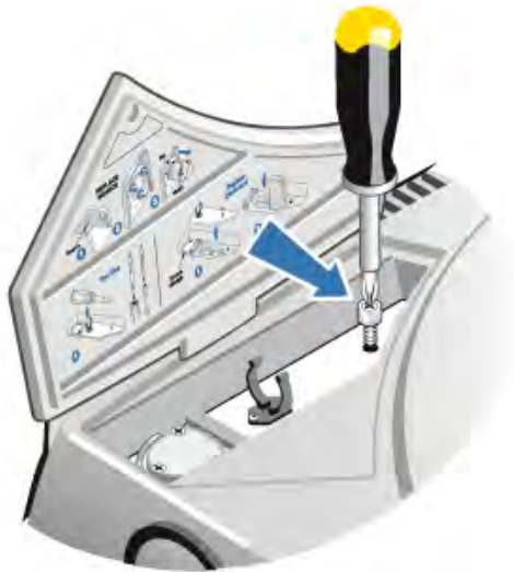
Abbildung 5-2: Entfernen der Trockenmittelabdeckung
