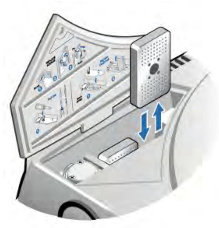
Figure 5-3 : Levage du couvercle de desséchant
