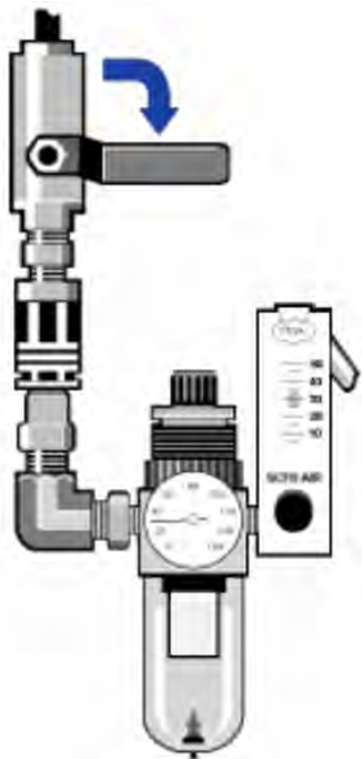
Figure 5-2 : Vanne du filtre de purge
