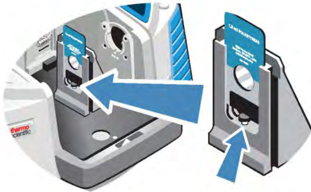
Figura 4-2: Ajustar la altura de la muestra
